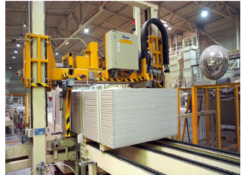
Рис.7. Участок формирования гипсокартонных листов в пачки.
