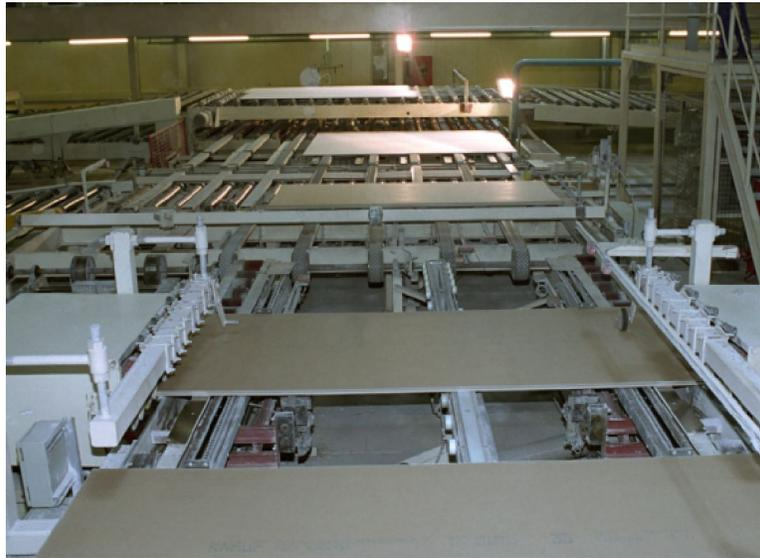
*Рис. 6. Участок фрезеровки торцов гипсокартонных листов.*
