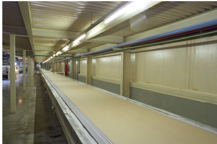
Рис.3. Участок транспортировки «сырого» гипсокартона
