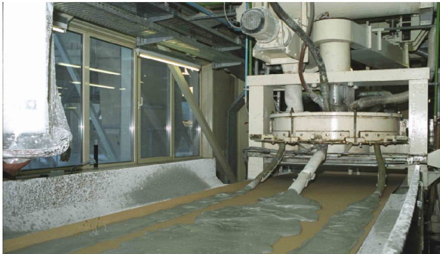
Рис.2. Участок заливки гипсового раствора на картонную ленту
