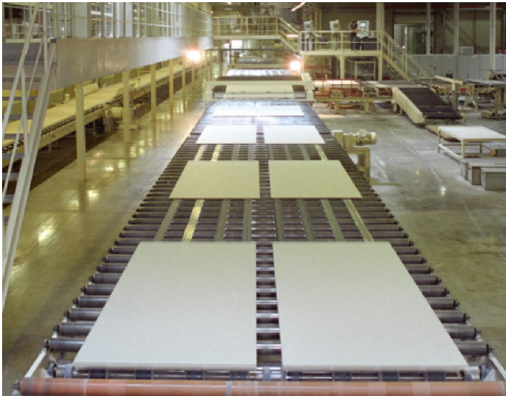
Рис.5. Участок выгрузки высушенных гипсокартонных листов из сушильной камеры.
