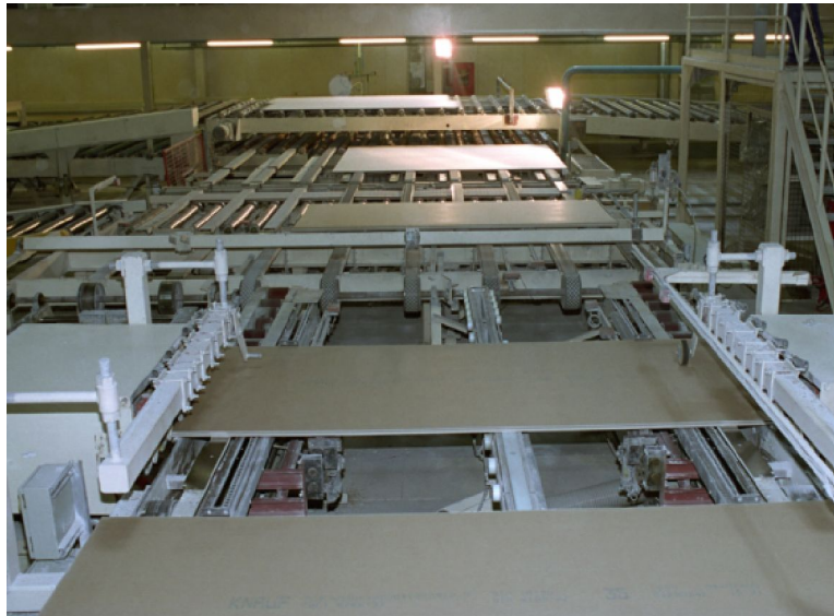
Рис. 6. Участок фрезеровки торцов гипсокартонных листов.
