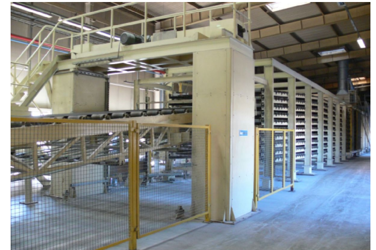
Рис.4. Участок высушивания гипсокартонных листов
