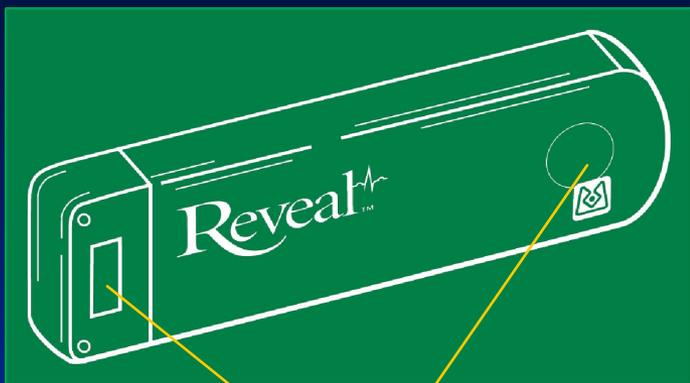
Электроды вмонтированы в корпус на расстоянии *38.5 mm*
