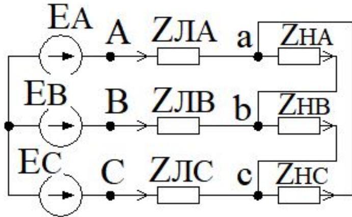
Расчет данной цепи довольно сложный, поскольку она 3-х контурная с 4-мя узлами. Задача упроститься, если треугольник сопротивлений заменить на эквивалентную звезду. Замена будет эквивалентной, если напряжения и токи во внешней части схемы не изменяются
