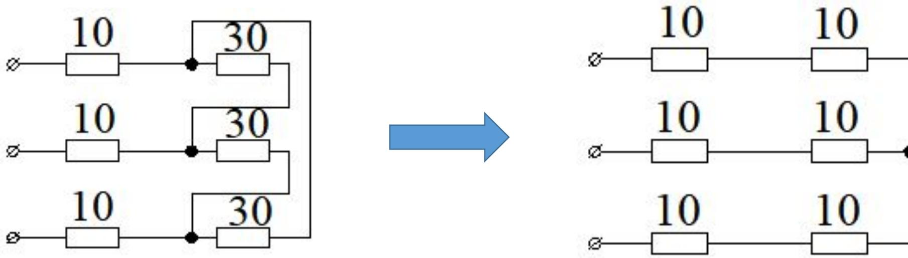
После замены  $\Delta$  нагрузки на  $Y$  нагрузки получаем схему, которую рассматривали ранее со звездой. Её рассчитываем методом двух узлов, находим линейные токи
