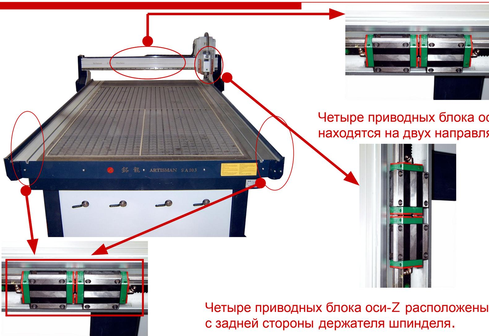
Четыре приводных блока оси Y находятся на двух направляющих.
