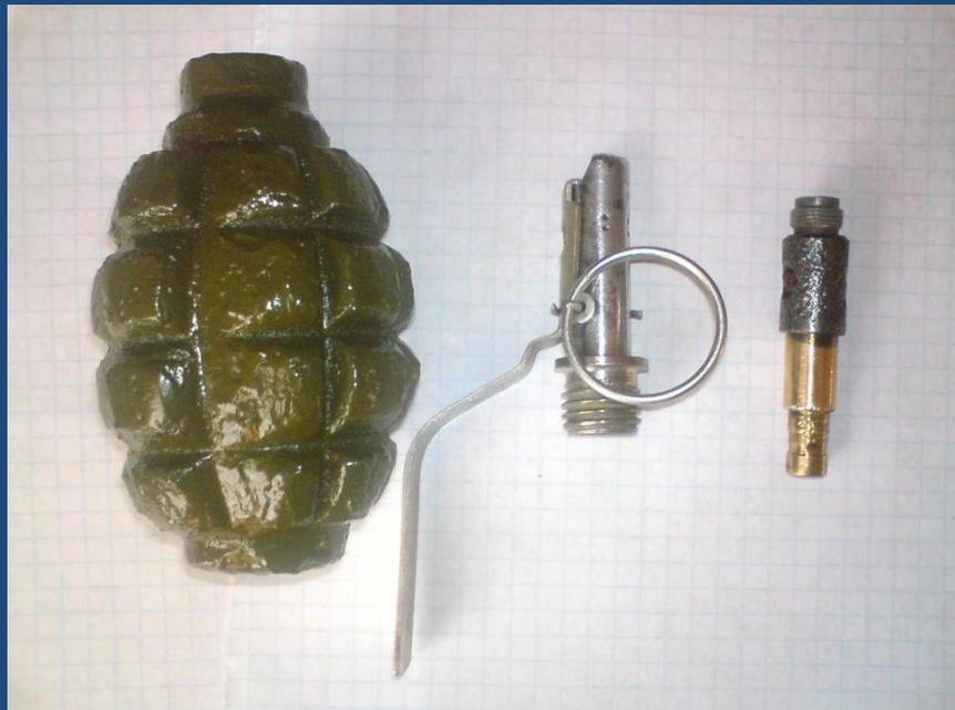
Запал для гранат УЗРГМ - унифицированный запал ручной гранаты модернизированный предназначенный для взрыва разрывного заряда. Он состоит из:
