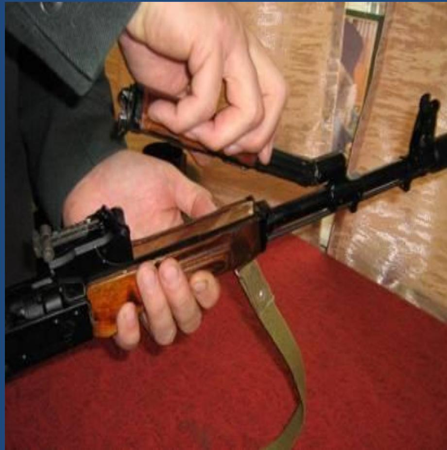
На прицеле с правой стороны поднять флажок замыкателя вертикально вверх и поднять деталь кверху.
