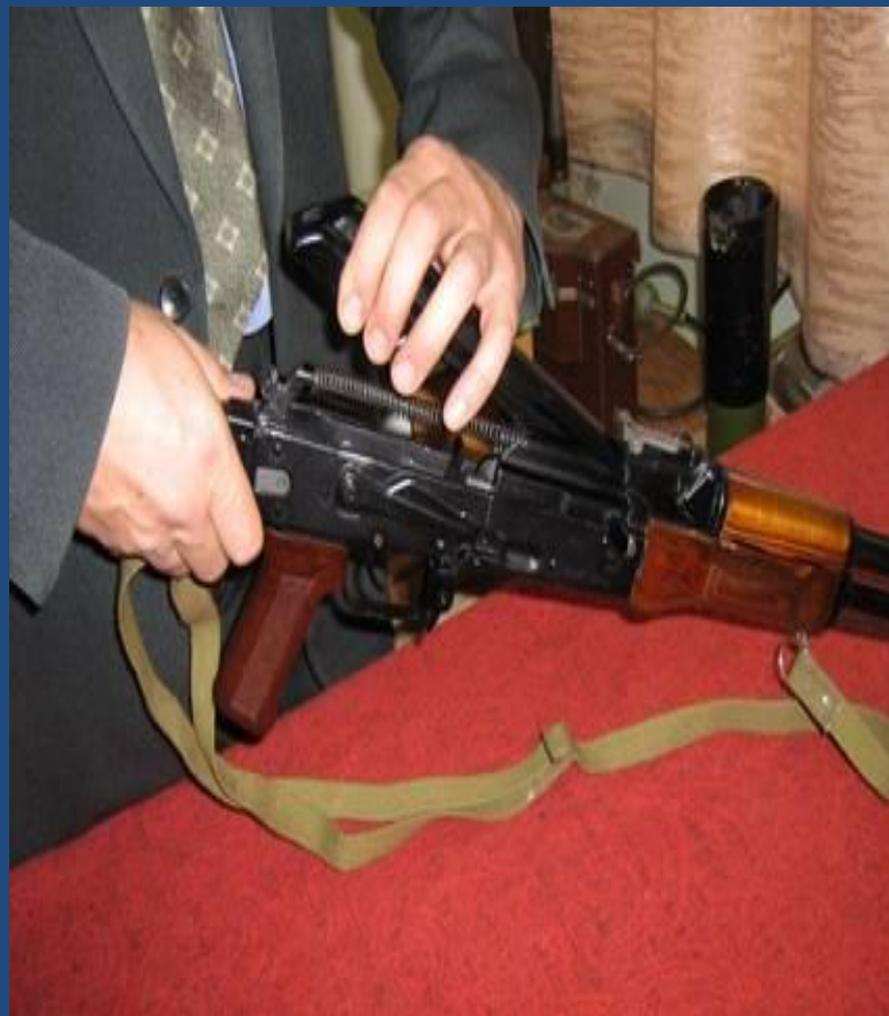
Большим пальцем правой руки нажать на выступ возвратного механизма и поднять крышку ствольной коробки кверху
