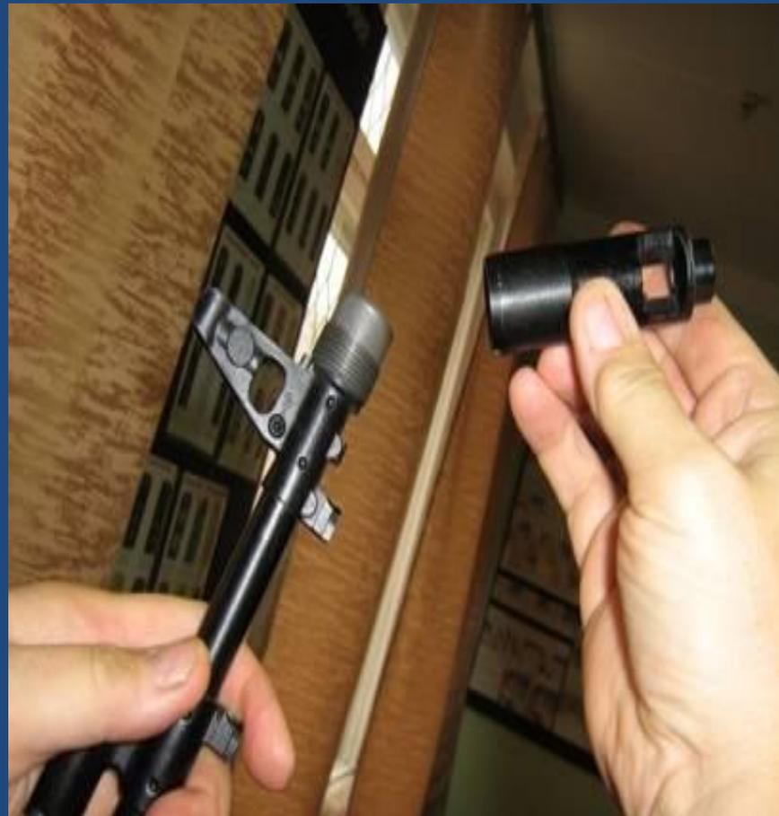
Нажать ногтем указательного пальца на фиксатор и вращая против часовой стрелки, отвинтить его.
