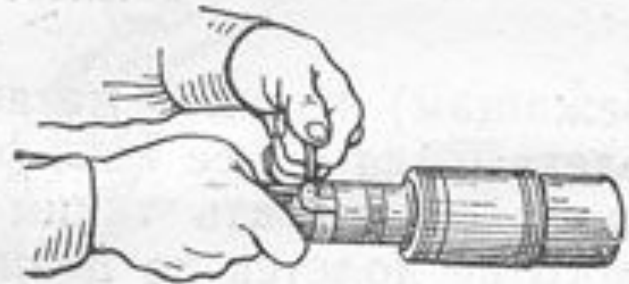
Выдергивание пре- дохранительной чеки
