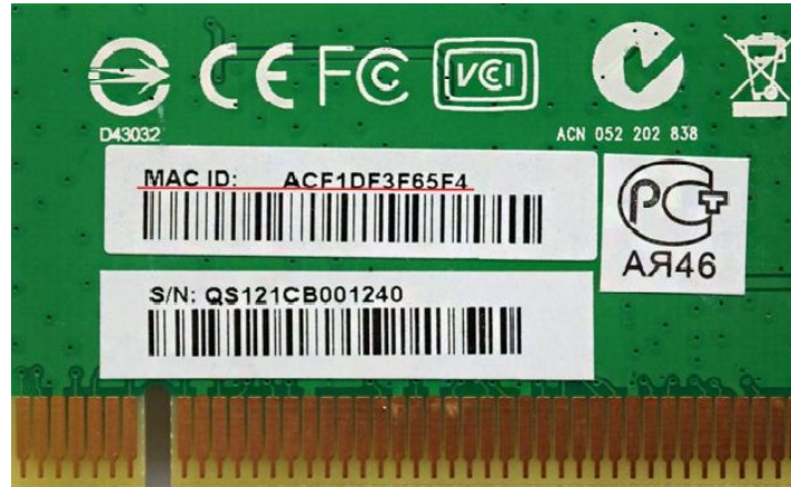
Пример MAC-адреса и серийного номера дискетной сетевой платы
