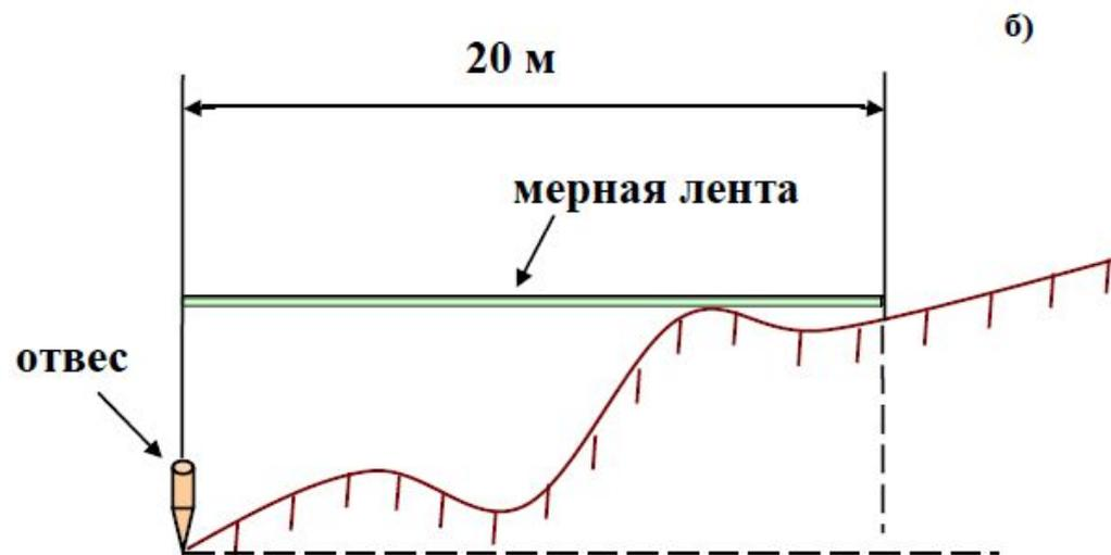
Рис. 56. Ватерпасовка: а) с использованием рейки и уровня ; б) с использованием горизонтально расположенной мерной ленты и отвеса
