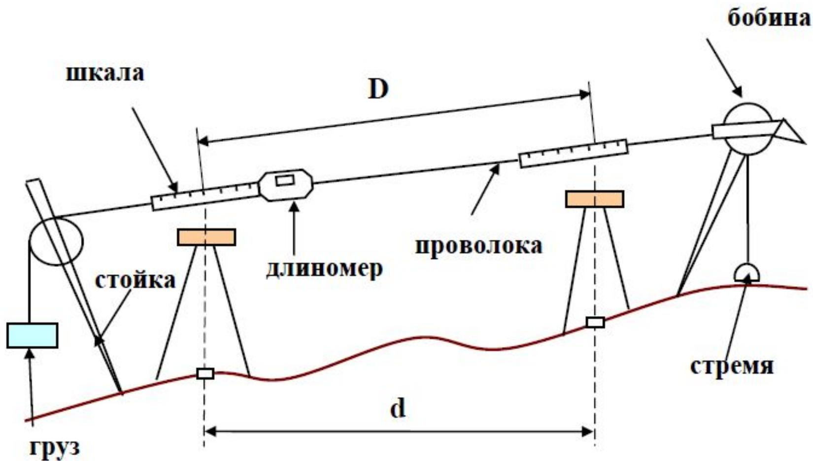
Рис. 57. Измерение расстояния длиномером
