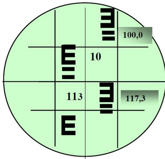
Рис. 60. Определение дальномерного расстояния: а) от оси вращения прибора до искомой точки; б) – по сетке нитей
