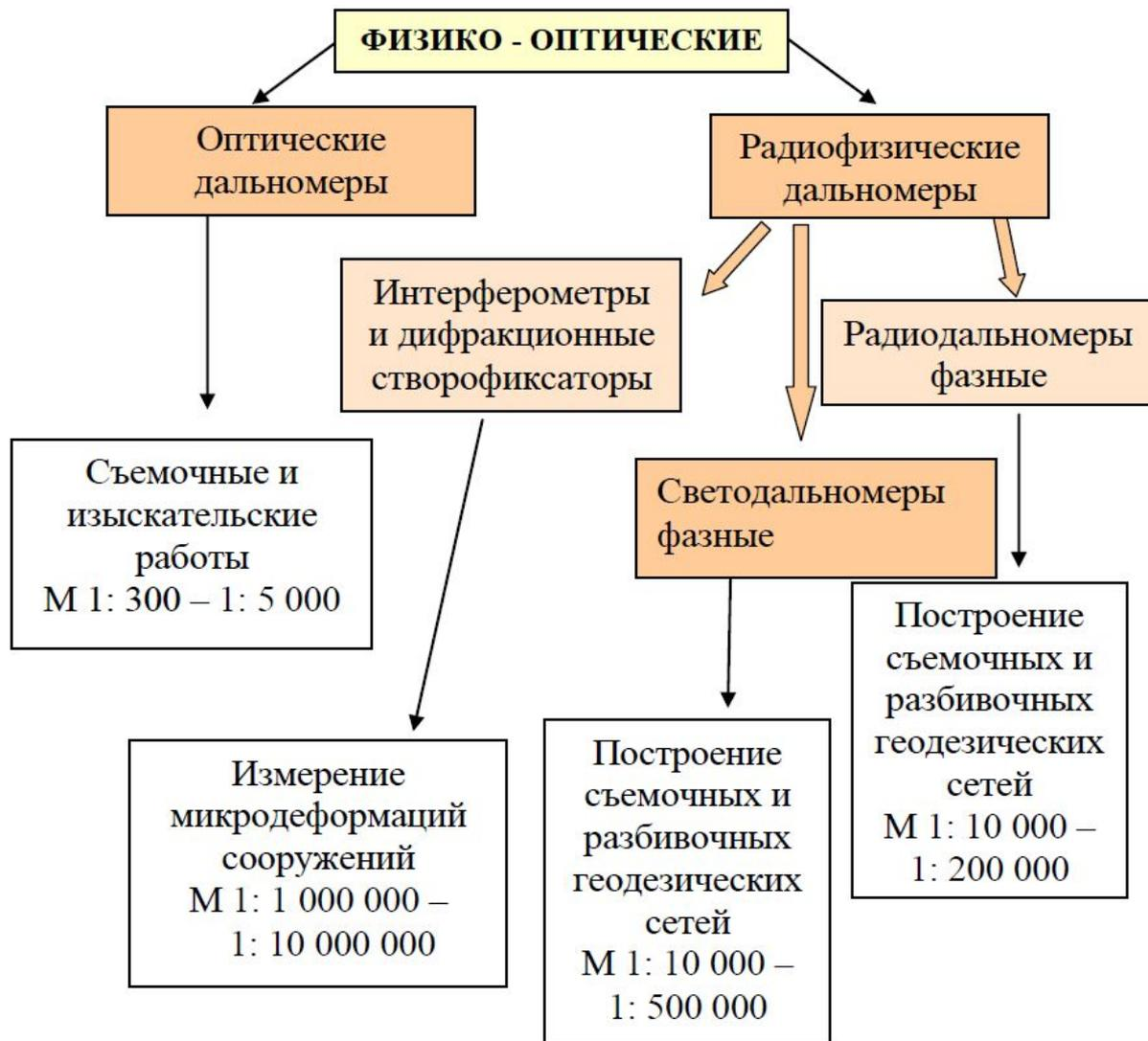
В зависимости от конкретных условий применяются разные методы и различные приборы. Широко применяются в инженерной геодезии
