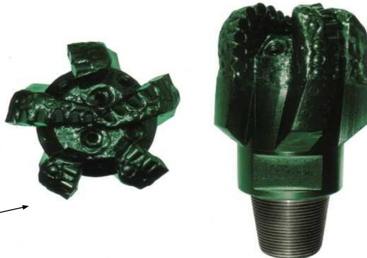
Долото PDC с алмазосодержащими композиционными вставками диаметром 215,9 мм для бурения мягких с пропластками средней твердости пород (количество лопастей – 5, количество промывочных узлов - 7)
