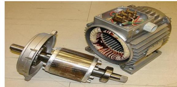
**Асинхронный двигатель** —
