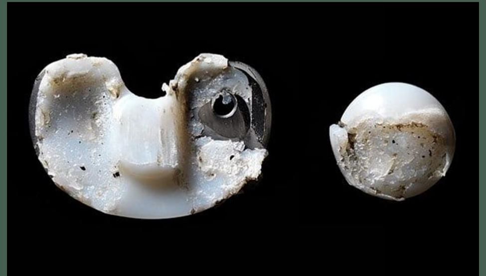
Пример вкладыша и тибиального компонента эндопротеза коленного сустава спустя 14 лет после имплантации.
