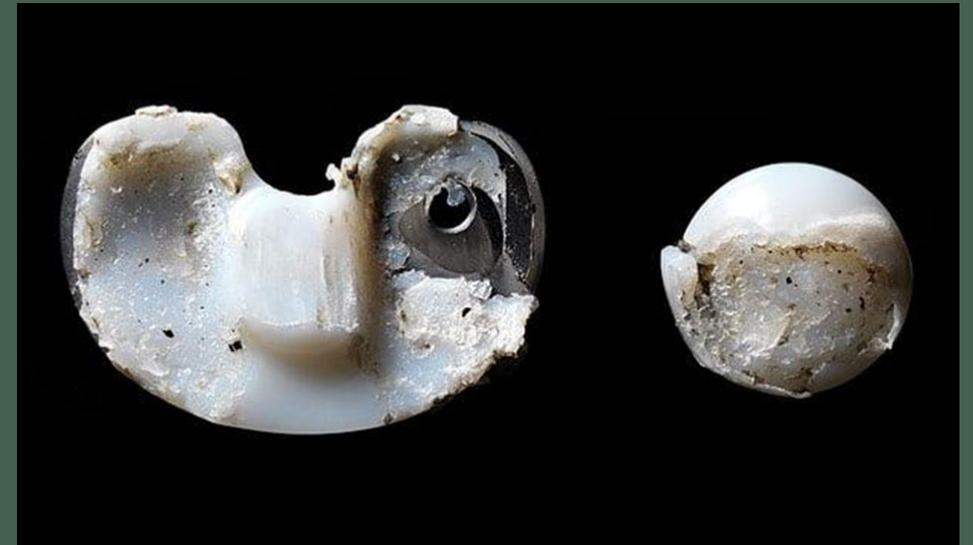
Пример вкладыша и тибиального компонента эндопротеза коленного сустава спустя 14 лет после имплантации.
