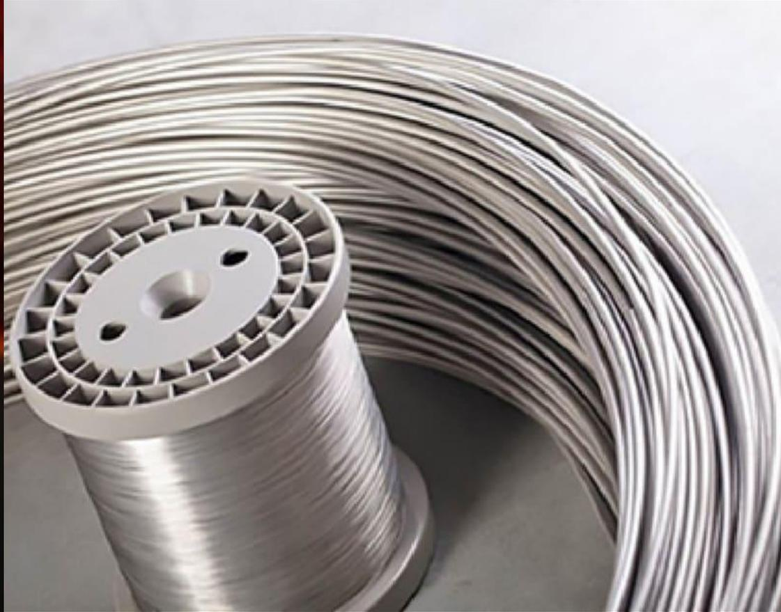
Устойчив к окислению на воздухе при высокой температуре. Представляет собой твёрдый, хрупкий сплав, с трудом поддающийся механической обработке, обладает высоким удельным электрическим сопротивлением 1,2-1,3 мкОм·м.
