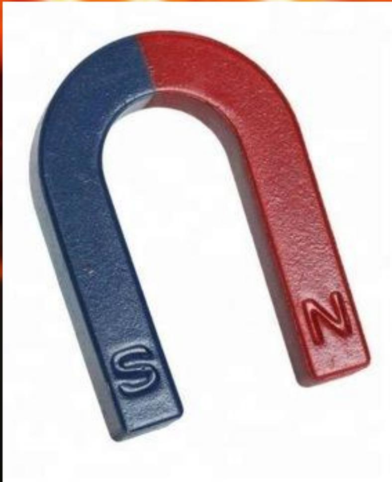
**Альнико** - сплав железа (53 %), алюминия (10 %), никеля (19 %) и кобальта (18 %).
