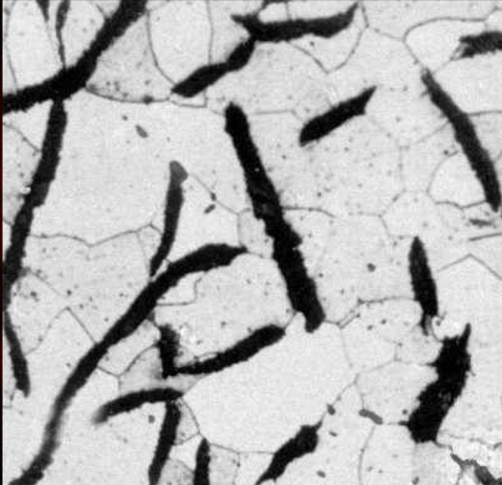
**Серый чугун** – твердый раствор  $\alpha$ -железа и углерода, который представлен в виде включений графита *пластинчатой формы*, и процентное содержание которого 2,14 – 6,67%.
