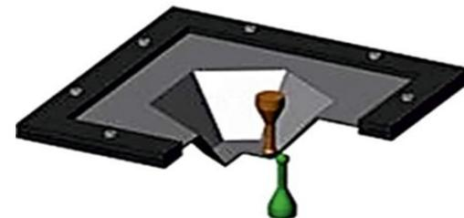
а - инкрементальная формовка с одним пуансоном;
