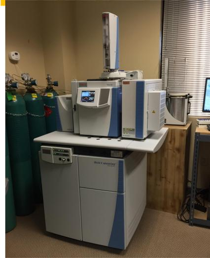
масс-спектрометрию соотношений стабильных изотопов (IRMS): в нашей лаборатории используется два аппарата для этого высокоспециализированного процесса.
