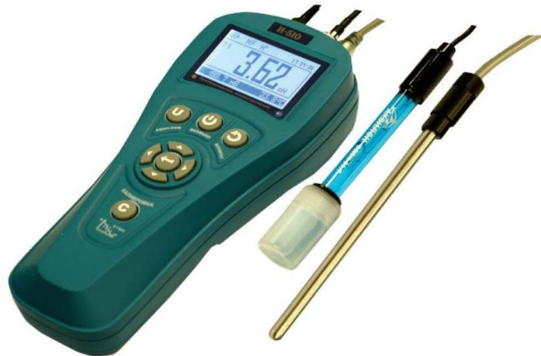
**Иономер И-510** предназначен для определения в водных растворах активности ионов водорода (pH), окислительно-восстановительного потенциала, концентрации (активности) различных ионов, а также для потенциометрического титрования.
