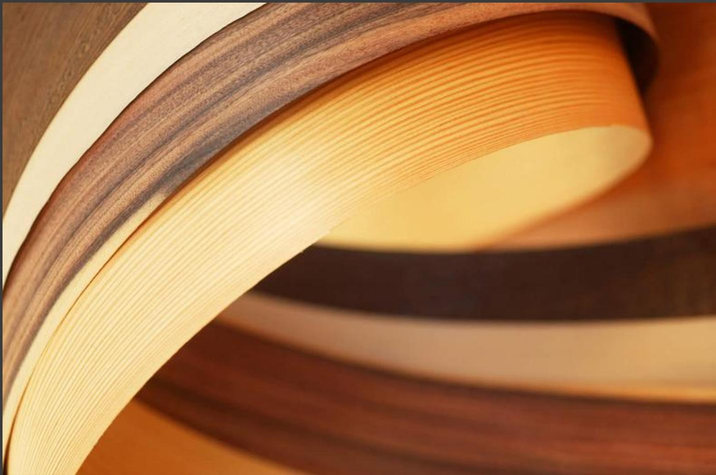
Лущеный шпон- натуральный пиломатериал, производящийся путем срезания пластов древесины из заранее заготовленных чурок на станках вкруговую. Вследствие применения такой технологии полученный лист получается такой ширины, какой была заготовка, что позволяет производителю срезать материал в необходимых размерах. Для заготовок используют в основном древесину таких пород как липа, береза, дуб, ольха, бук и
