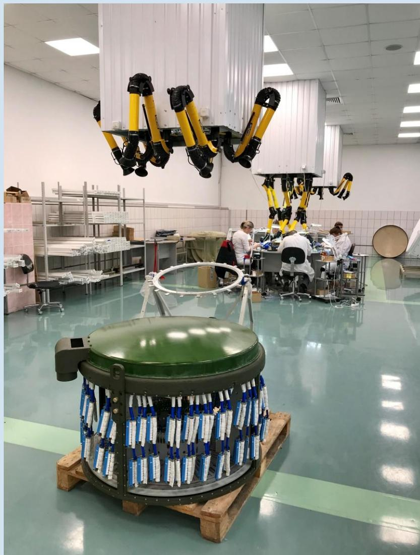
Так как разрабатываемые в АО “Щегловский вал” боевые модули в дальнейшем должны безотказно работать в условиях тропического климата и крайнего севера, готовую сборку подвергают климатическим испытаниям в специальной камере. После чего продукция готова к сдаче представителю заказчика.
