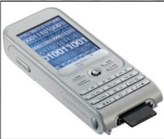
*сотовый телефон Sagem vectroTEL X8 обеспечивает абсолютную конфиденциальность переговоров посредством специальной встроенной системы шифрования, базирующейся на использовании алгоритма Диффи-Хеллмана с 1024-битным ключом*
