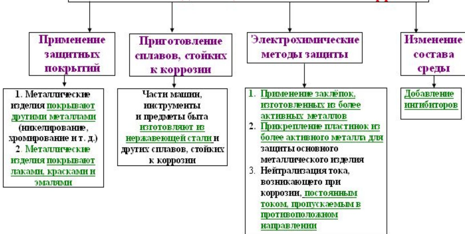
Коррозия обусловлена не только действием кислорода, воды или ионов водорода на сплавы металлов и металлы, но и электрохимическими процессами (переходом электронов), которые возникают из-за наличия контактов в сплавах между металлами и различными неоднородными включениями
