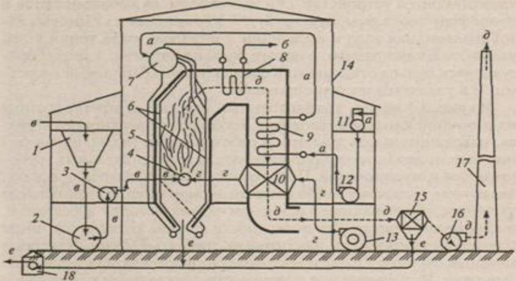
1 – бункер сырого угля; 2 – углеразмольная мельница; 3 – вентилятор; 4 – горелка; 5 – топка котла; 6 – трубная система; 7 – барабан котла; 8 – пароперегреватель; 9 – водяной экономайзер; 10 – воздухоподогреватель; 11 – бак питательной воды; 12 – питательный насос; 13 – дутьевой вентилятор; 14 – котельная; 15 – золоулавливающее устройство; 16 – дымосос; 17 – дымовая труба; 18 – багерный насос
