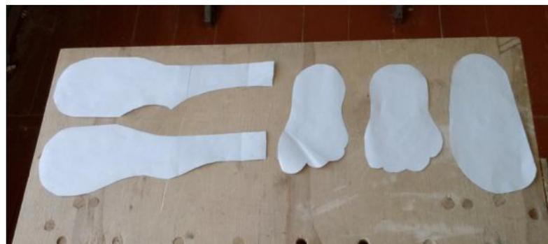
Наносим по шаблону рисунок на пласт, заранее склеенную из 2 досок.
