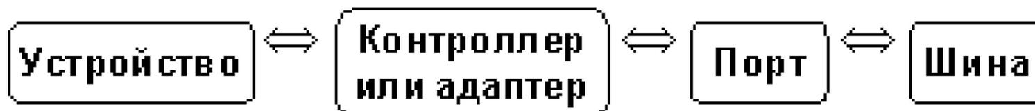
**Контроллеры и адаптеры** представляют собой наборы электронных цепей, которыми снабжаются устройства компьютера с целью совместимости их интерфейсов. Контроллеры, кроме этого, осуществляют непосредственное управление периферийными устройствами по запросам микропроцессора.
