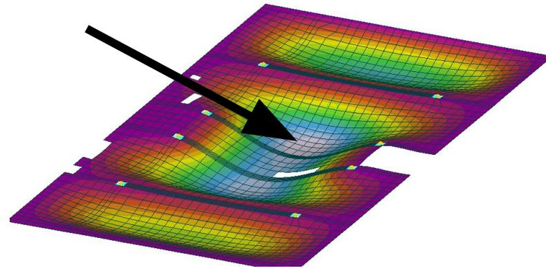
перемещение узла при длительных характеристиках бетона
