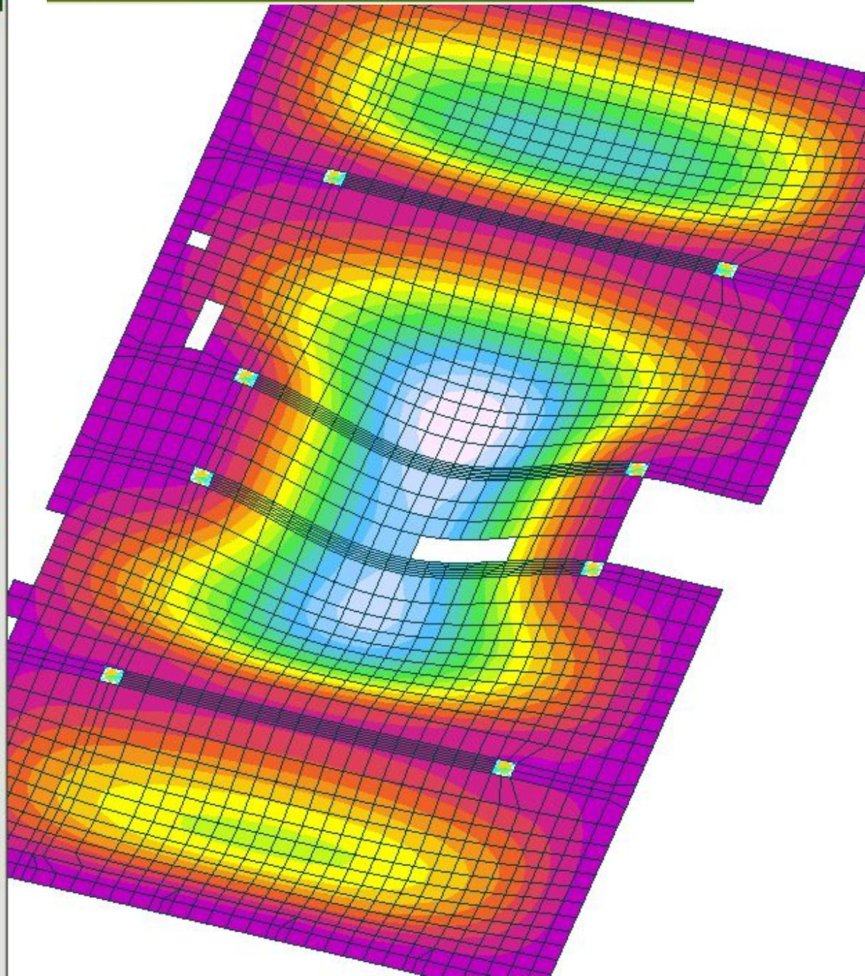
Перемещения при пониженной влажности (значение  $\varphi_{b,cr} = 3$  и  $E_{b,T} = 34500/(1+3) = 8625$  МПа.)
