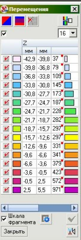
Результаты расчета прогибов перекрытия с учетом последовательности возведения (режим МОНТАЖ) в режиме линейного расчета. Жесткости перекрытий снижены умножением модуля упругости бетона на обобщенный коэффициент 0,3.
