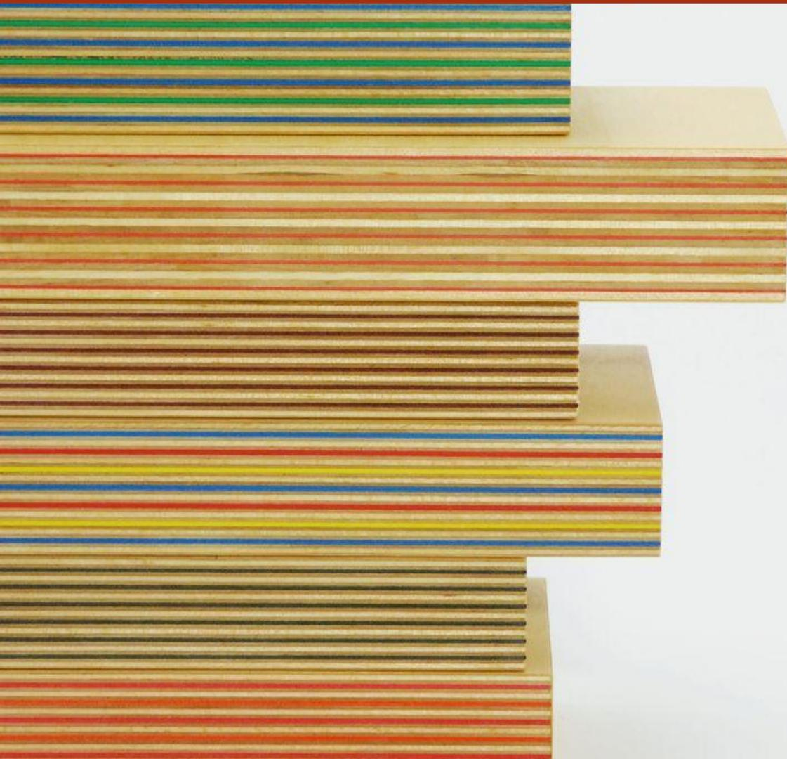
□ **КОНСТРУКТИВНЫЙ СЛОЙ**- Он представляет собой несколько склеенных между собой листов шпона. При производстве конструктивного слоя декоративной фанеры используется эпоксидная смола для склейки шпоновых полотен, причем принцип склеивания заключается в соблюдении чередования волокон шпона в соседних полотнах. Как правило, один (реже – два) слой шпона подбирается из ценных пород древесины – они имеют оригинальный рисунок и являются началом декоративного слоя.
