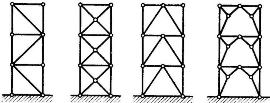
Связевые конструкции многоэтажных промышленных зданий.
