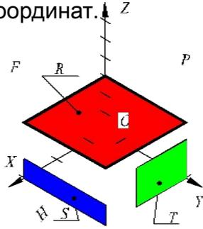
**Проецирующая плоскость** – плоскость, перпендикулярная плоскости проекций. Она параллельна одной из осей координат. На плоскости проекций, которой она перпендикулярна, проецируется в виде наклонной линии. Все геометрические объекты, находящиеся на этой плоскости, проецируются в ту же линию.
