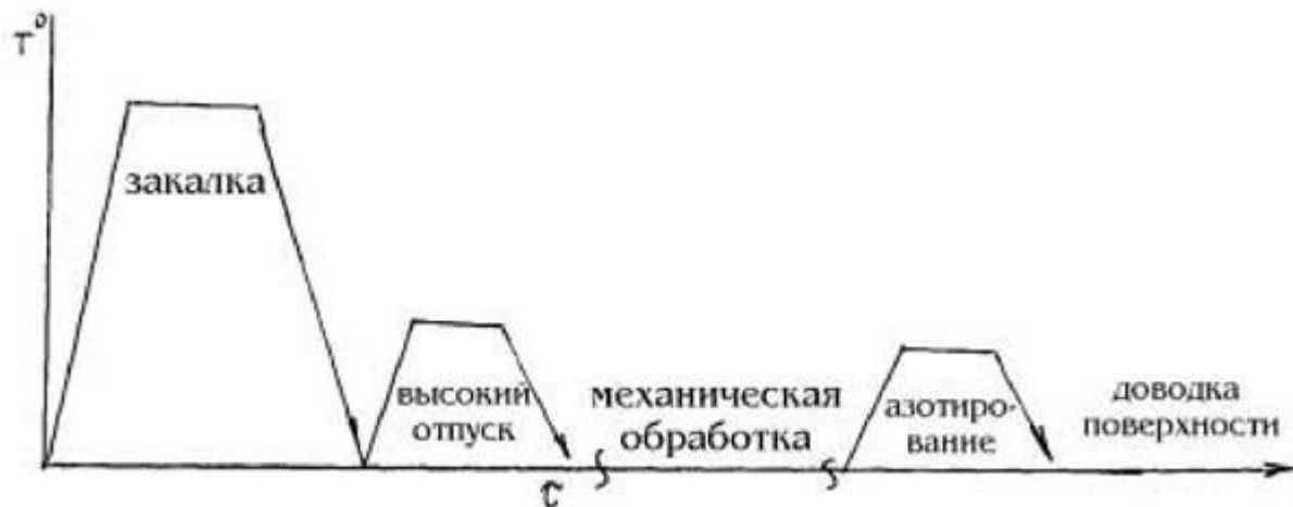
Рисунок 2 - Схемы возможных вариантов термообработки с Азотированием
