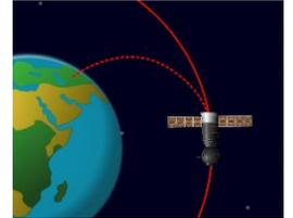
Корабль поднимается выше с помощью маневра, известного как гомановский переход. Двигатель включается два раза. Первый импульс выводит аппарат на новую высоту по эллиптической траектории. Второй позволяет остаться на этой высоте и занять круговую орбиту.
