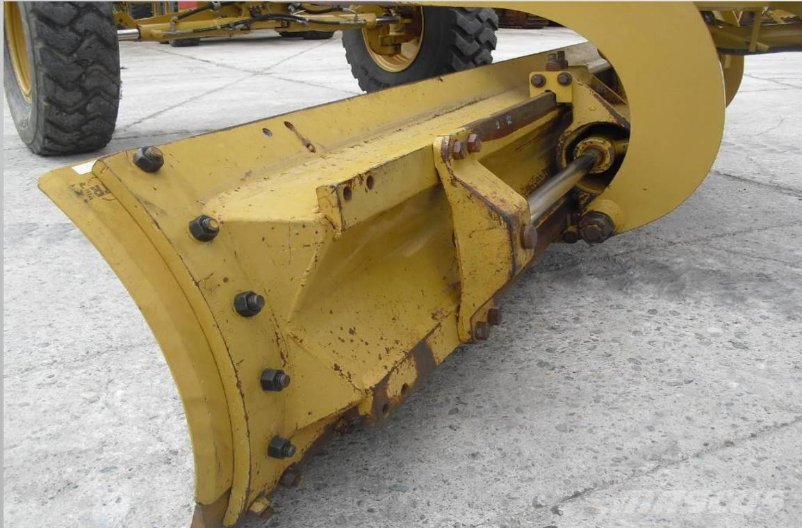
Рисунок 2- отвал автогрейдера
