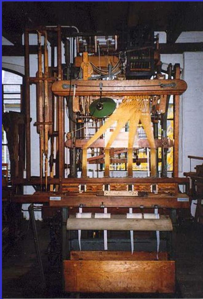
В 1804 году Жозеф Мари Жаккар разработал ткацкий станок, в котором вышиваемый узор определялся перфокартами. Серия карт могла быть заменена, и смена узора не требовала изменений в механике станка. Это было важной вехой в истории программирования.
