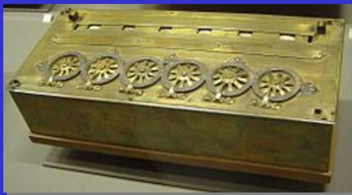
Суммирующая машина Паскаля (1642) представляла собой механическое устройство в виде ящичка с многочисленными связанными одна с другой шестерёнками. Складываемые числа вводились в машину при помощи соответствующего поворота наборных колёсиков.
