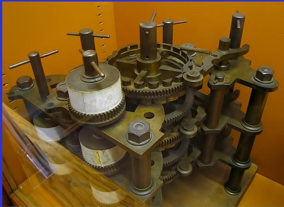
В 1835 г. Чарльз Бэббидж описал свою аналитическую машину. Это был проект компьютера общего назначения с десятичной системой счисления, с применением перфокарт в качестве носителя входных данных и программы, а также парового двигателя в качестве источника энергии. Одной из ключевых идей было использование шестерней для выполнения математических функций. Воплотить проект в жизнь автору не удалось.
