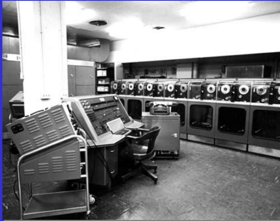
В 1951 г. в компании Remington Rand был создан UNIVAC, который стал первым массово производимым компьютером, было выпущено 46 экземпляров. Компьютер состоял из 5200 электровакуумных ламп, и потреблял 125 кВт энергии. Использовались ртутные линии задержки, хранящие 1000 слов памяти, каждое по 11 десятичных цифр плюс знак (72-битные слова).
