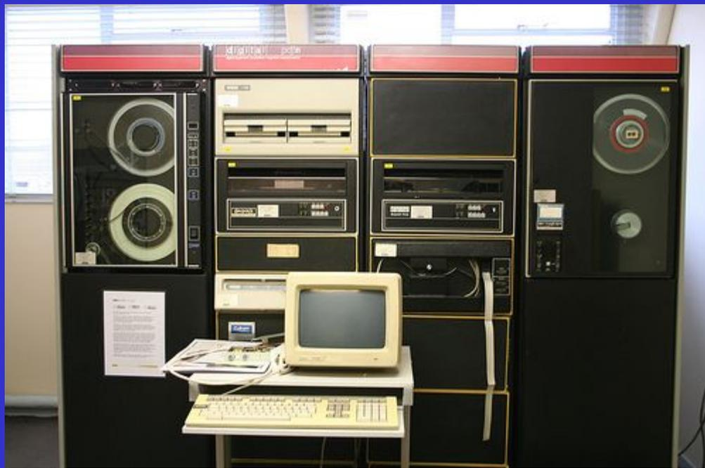
Чтобы не проиграть в конкурентной борьбе, фирма DEC создала 16-битный миникомпьютер PDP-11. Многочисленные инновации, в числе которых общая шина UNIBUS, сделали архитектуру PDP-11 лидером компьютерной индустрии. Первой моделью стала PDP-11/20, которая затем была заменена на высокопроизводительные модели 11/30, 11/45 и 11/70. Эти машины имели быстродействие в 1 млн опер./с и ОЗУ емкостью 256 Кбайт. В СССР аналогом PDP-11 была серия СМ ЭВМ.
