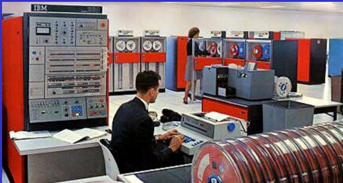
Фирма IBM первой реализовала семейство ЭВМ – серию совместимых друг с другом компьютеров – от небольших до самых мощных и дорогих моделей. Наибольшее распространение получило 32-битное семейство System/360, аналогом которого в СССР стала серия ЕС ЭВМ.
