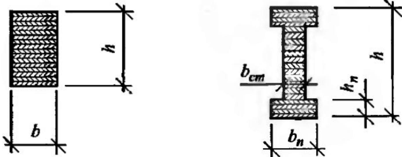
*Рис. 7.26. Обозначения, принятые при расчете клееных балок.*
