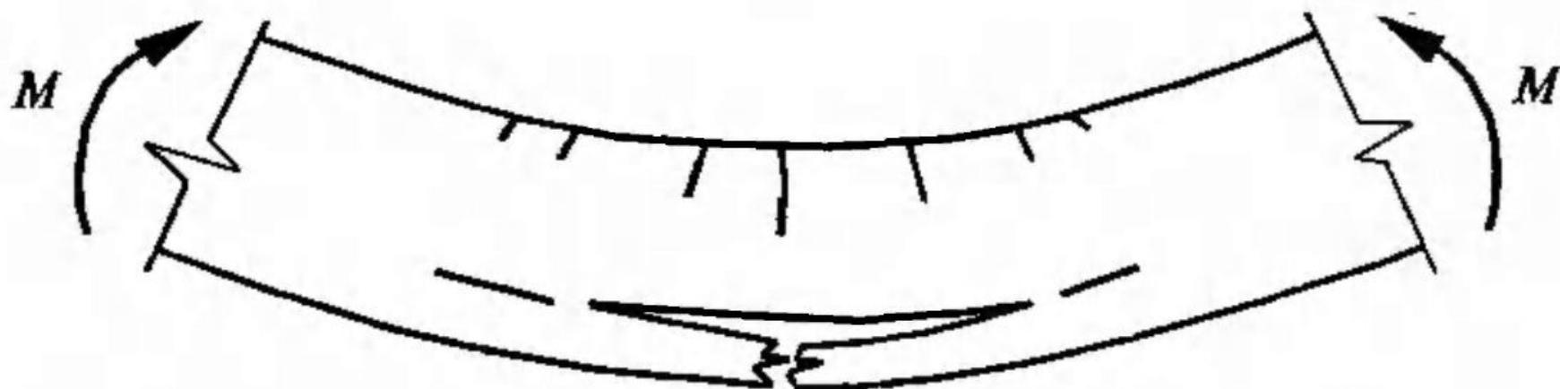
*Рис. 7.22. Характер разрушения деревянного изгибаемого элемента*
