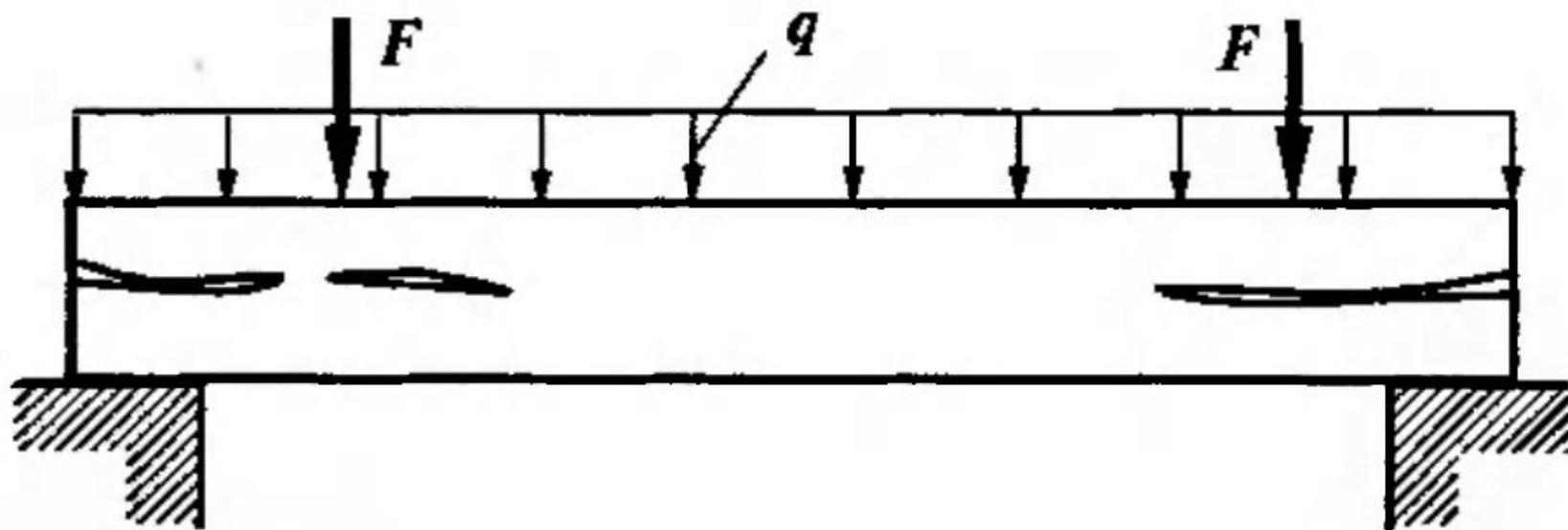
Рис. 7.23. Разрушение деревянной балки в результате сдвига
