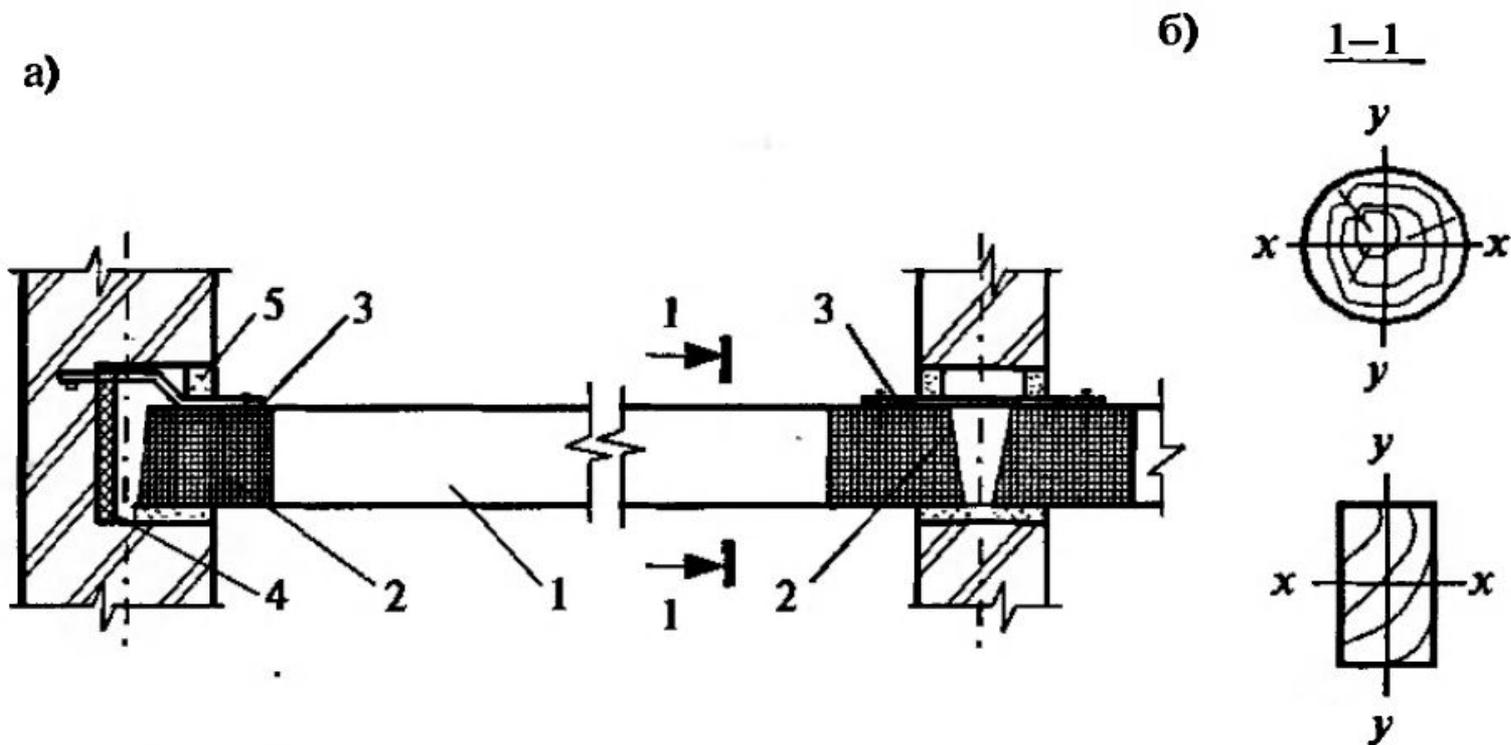
**Рис. 7.17. Вариант опирания деревянной балки на кирпичные стены:**
