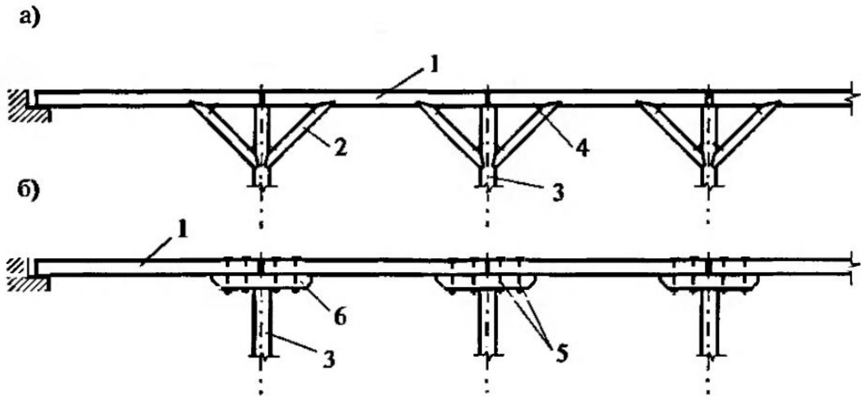
Рис. 7.18. Схемы прогонов: а) разрезные прогоны с подкосами; б) разрезные прогоны с подбалками; 1 — прогон; 2 — подкос; 3 — стойка; 4 — скоба; 5 — болты; 6 — подбалка
