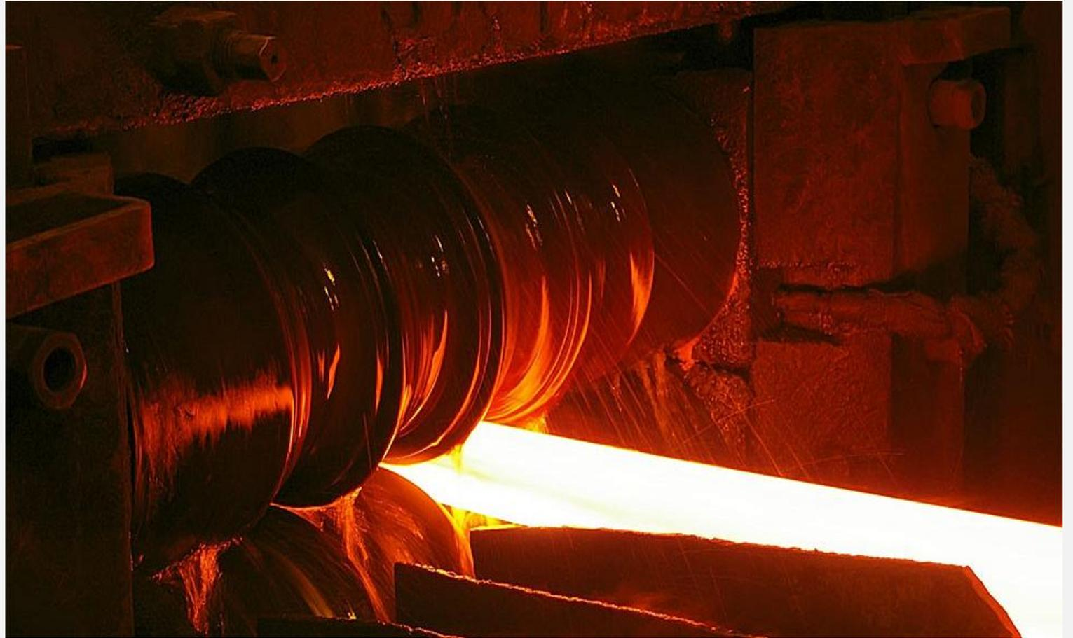
**3. Поперечно-винтовая.** Валки располагаются под углом друг к другу, вращаясь в разные стороны. Заготовка получает вращательное и поступательное движение. Применяется для получения бесшовных труб и проката с периодическим профилем.
