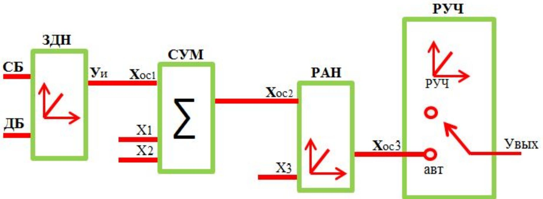
Если в задатчике ЗДН балансировка отсутствует ( $СБ=ДБ=0$ ), то переход на режим автоматического управления произойдет безударно, при этом  $\Pi$  и  $Д$  – части начального сигнала рассогласования = 0 (т.е. в первый момент после включения алгоритм РАН работает как И-регулятор).
