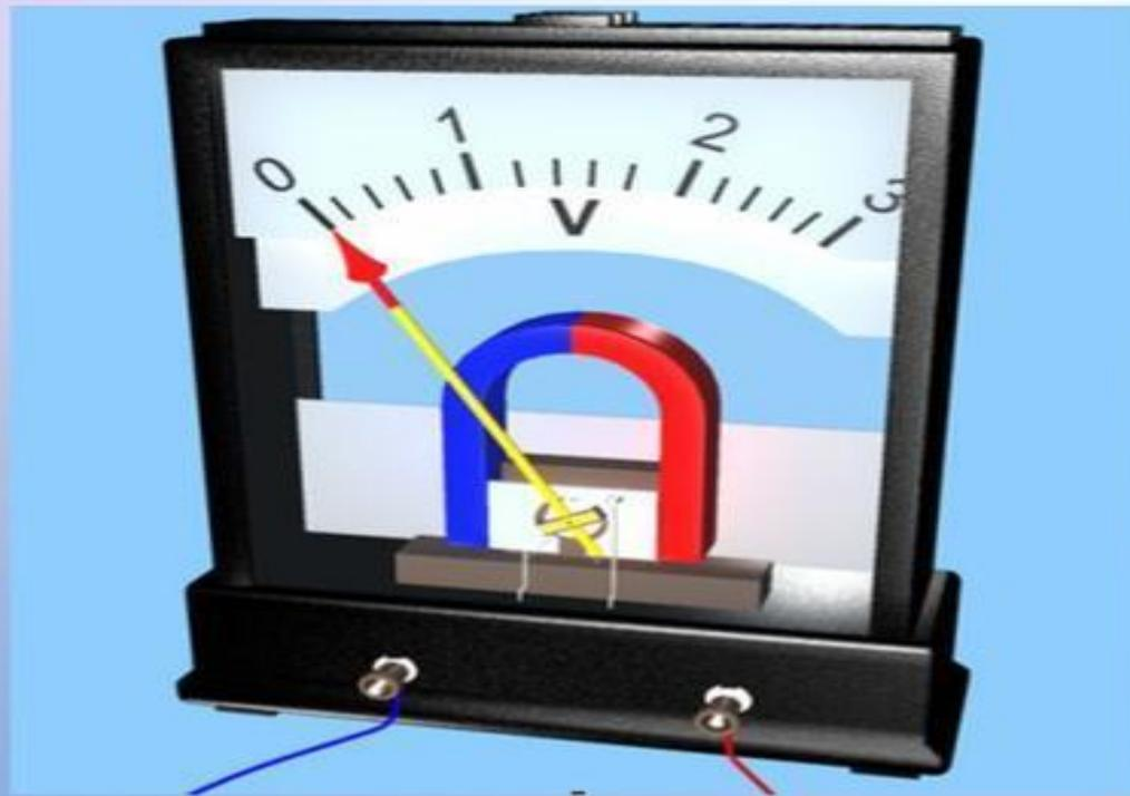
Измерительный механизм магнитоэлектрической системы, снабжён набором шкал и дополнительных сопротивлений.
