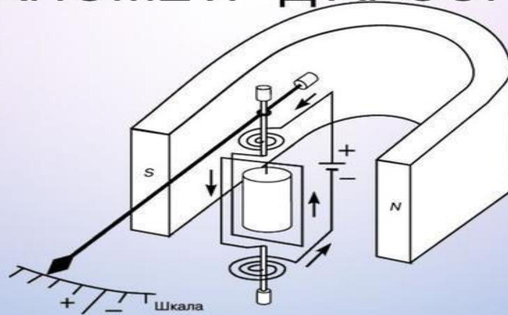
**ГАЛЬВАНОМЕТР Д'АРСОНВАЛЯ** - высокочувствительный электроизмерительный прибор для измерения слабых токов или напряжений. Принцип его работы основан на магнитном действии тока.
