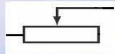
**РЕОСТАТ**– устройство с переменным сопротивлением, предназначенное для регулирования силы тока и напряжения в электрической цепи; в данной конструкции перемещающийся ползунок позволяет пропускать ток по различному числу витков провода, намотанного на цилиндр.
