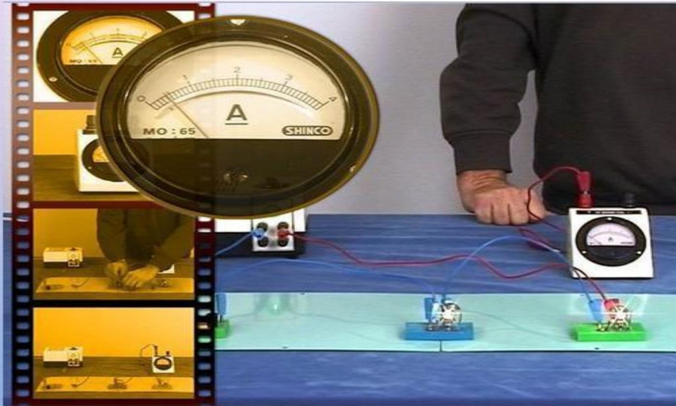
Амперметр включают в электрическую цепь **ПОСЛЕДОВАТЕЛЬНО** с потребителем, соблюдая полярность.
