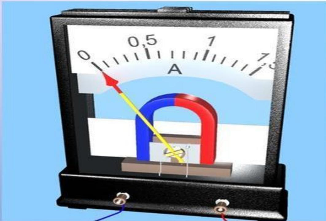
Измерительный механизм магнитоэлектрической системы, снабжён набором шкал и шунтов.
