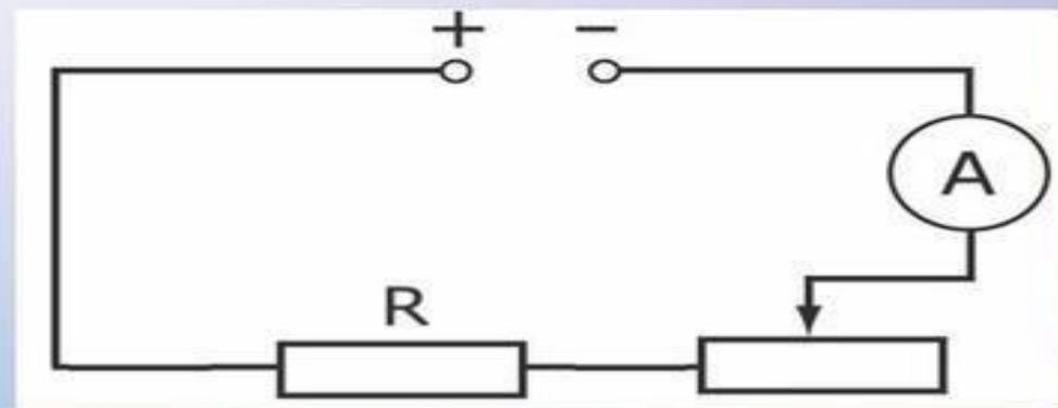
Регулирование напряжения реостатом
