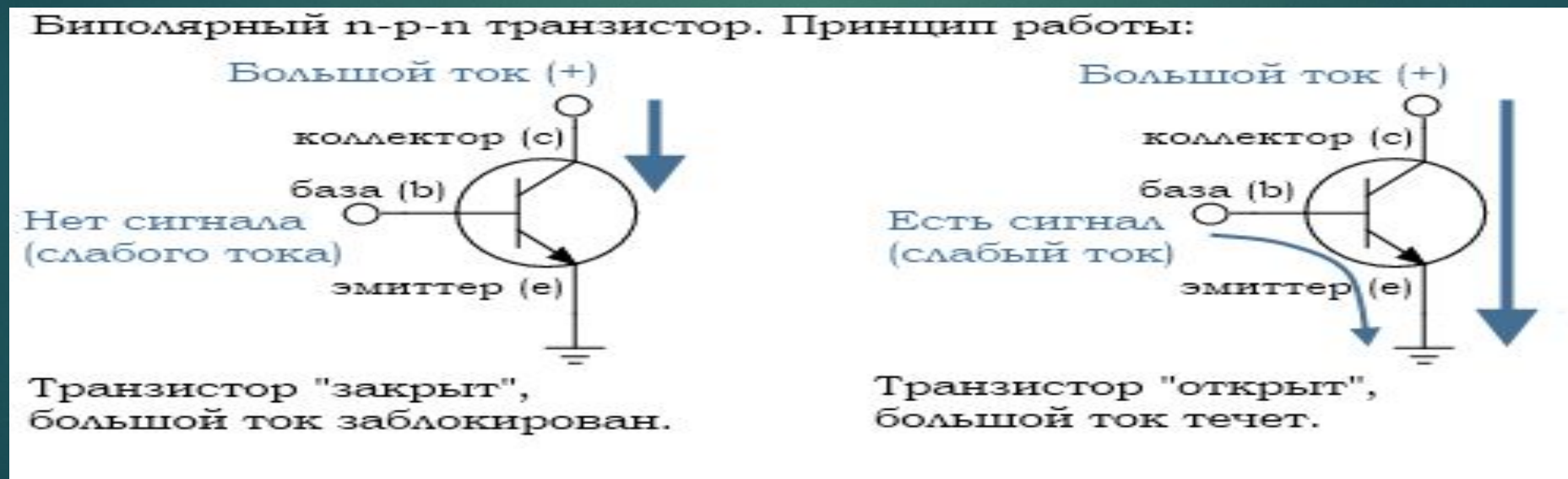
Рис. 42 - Принцип работы биполярного n-p-n транзистора
