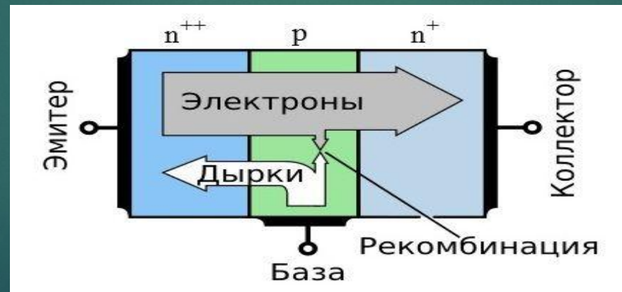
Рис. 41 - Строение биполярного транзистора
