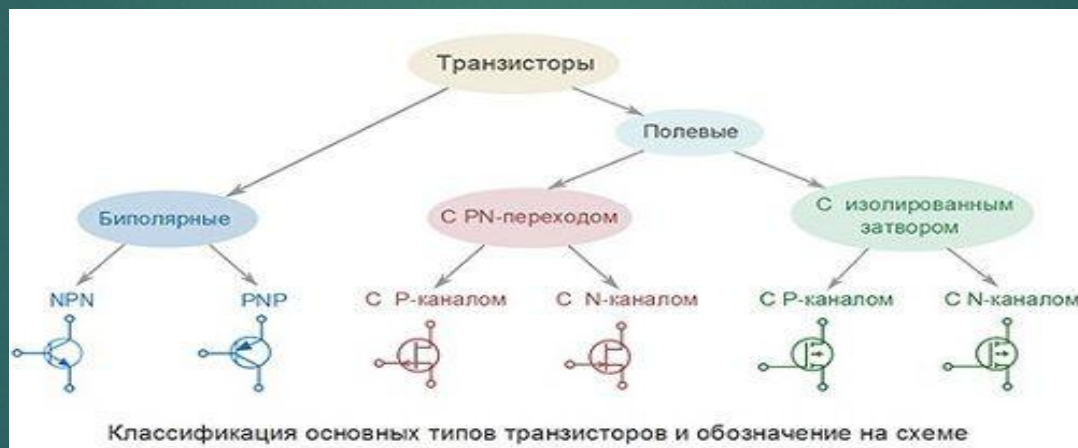
Рис. 40 - Схема классификации основных типов транзистора
