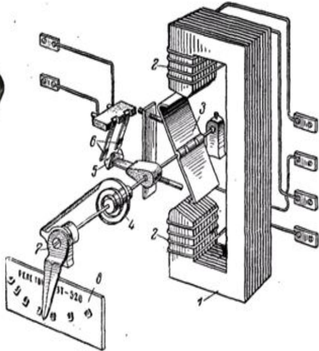
1 – сердечник; 2 – катушки обмотки; 3 – якорь; 4 – пружина; 5 – контактный мостик; 6 – неподвижный контакт; 7 – наружный указатель; 8 - шильдик.
