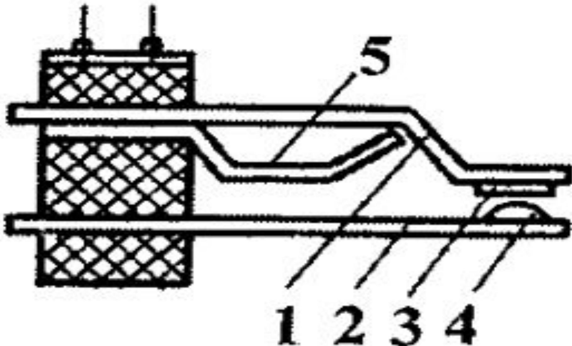
1,2 – токопроводящие элементы; 3,4 – контактные накладки; 5 –
