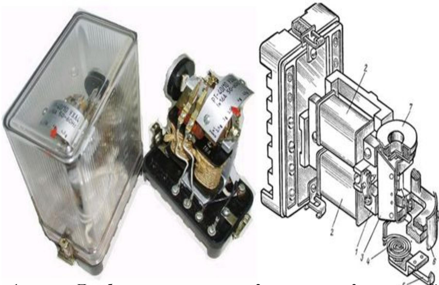
1 – полюса П – образного магнитопровода; 2 – катушка тока; 3 – поворотный Г – образный якорь; 4 – спиральная пружина; 5 – рычаг регулировки натяжения пружины (регулировка тока срабатывания); 6 – шкала; 7 – тормозной барабанчик с песком. Рисунок 4. Реле РТ-40 и его устройство
