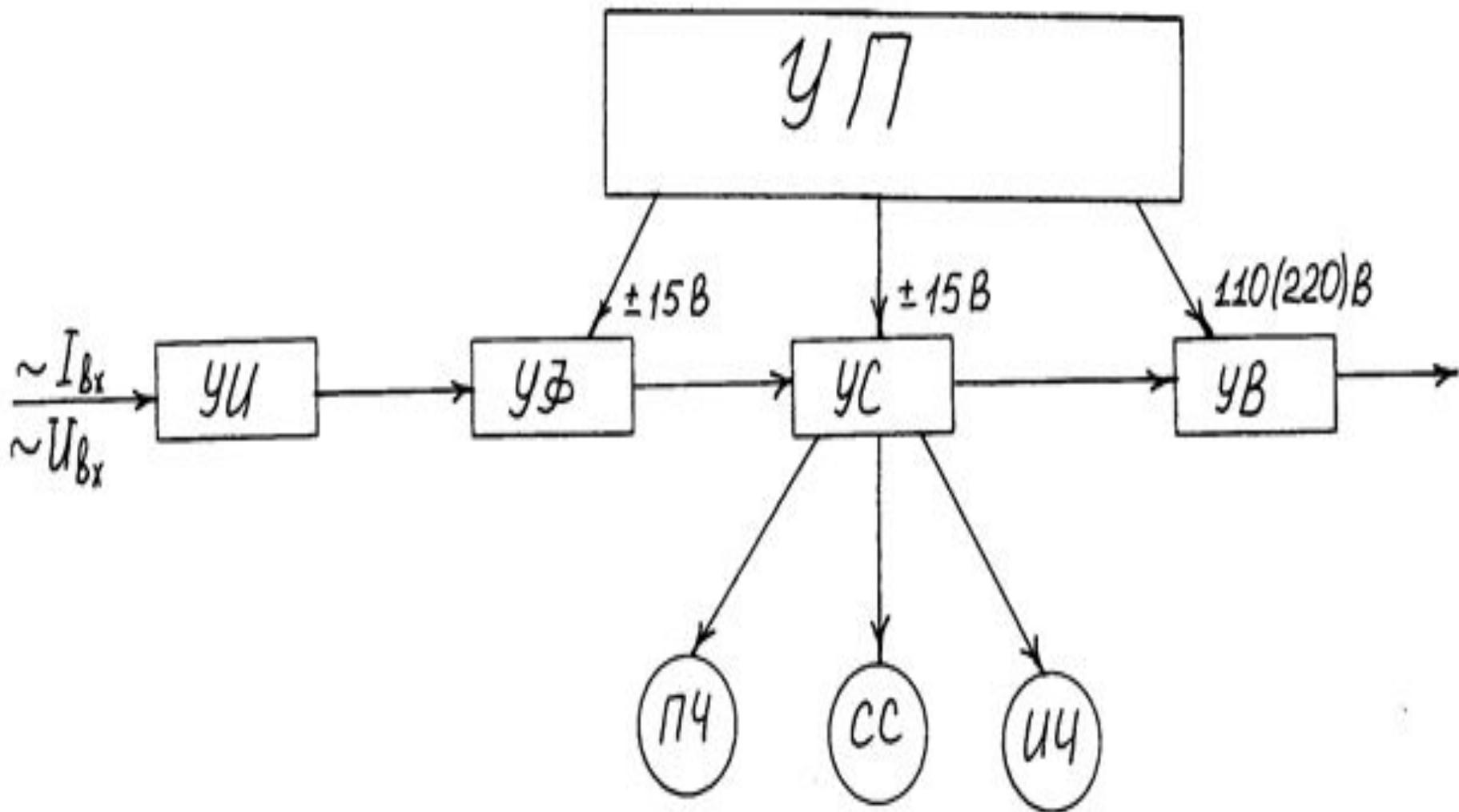
УП - узел питания; УИ - узел измерения; УФ - узел формирования; УС – узел сравнения (ПЧ - преобразующая часть, СС - схема сравнения, ИЧ - исполнительная часть); УВ - узел выхода
