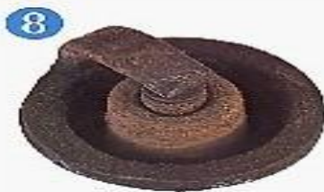
8 Холодная свеча или богатая смесь Но хорошо
