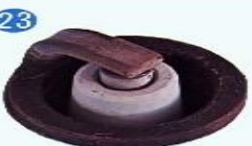
23 Горячая свеча или бедная смесь Но хорошо
