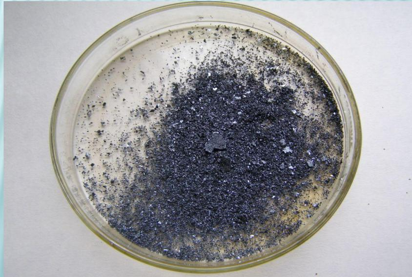
На дно стакана помещают технический йод, подлежащий очистке. стакан накрывают круглодонной колбой, заполненной холодной водой, ставят на песочную баню и включают нагрев.
