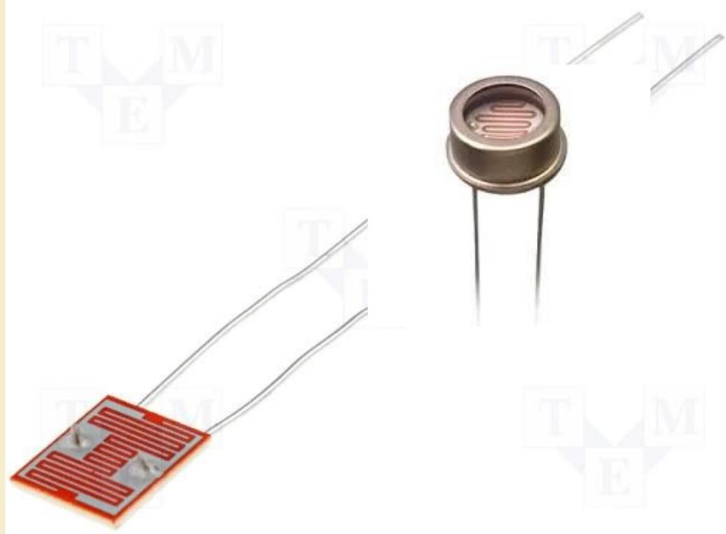
Непосредственный контакт между гребенками отсутствует, в результате между зубцами гребенок оказывается слой светочувствительного полупроводника.
