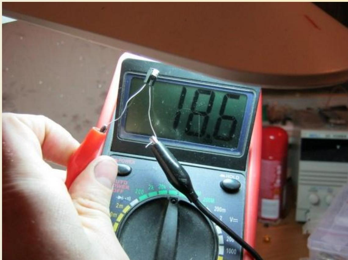
У фоторезисторов обязательно определен и диапазон температуры. Если использовать датчик при разных температурах, то следует обязательно ввести уточняющие преобразования, т.к. свойство сопротивления зависит от внешней температуры.
