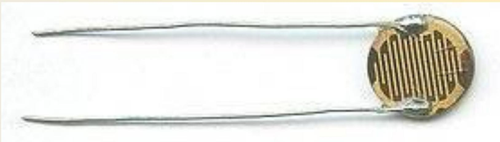
При освещении слоя полупроводника увеличивается число электронов, переходящих в зону проводимости, увеличивается электропроводность, вследствие чего изменяется сопротивление между напыленными участками металла.
