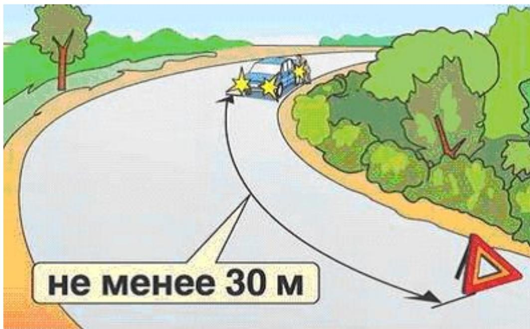
**7.3. При отсутствии или неисправности аварийной сигнализации на буксируемом механическом транспортном средстве на его задней части должен быть закреплен знак аварийной остановки.**
