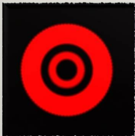
ДИФРАКЦИОННАЯ КАРТИНА ОТ КРУГЛОГО ОТВЕРСТИЯ
