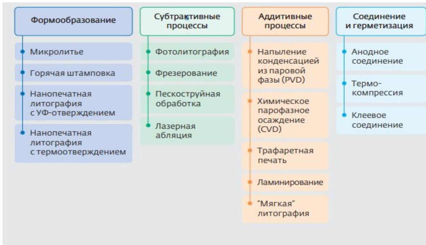
Классификация технологий, применяемых для изготовления микрофлюидных модулей
