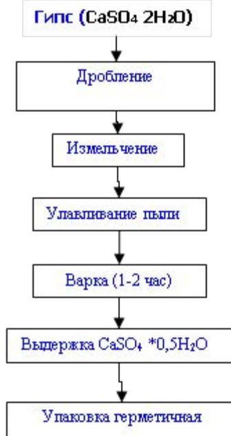
Схема получения  $\alpha\text{-CaSO}_4 \cdot 0,5\text{H}_2\text{O}$  в водной среде
