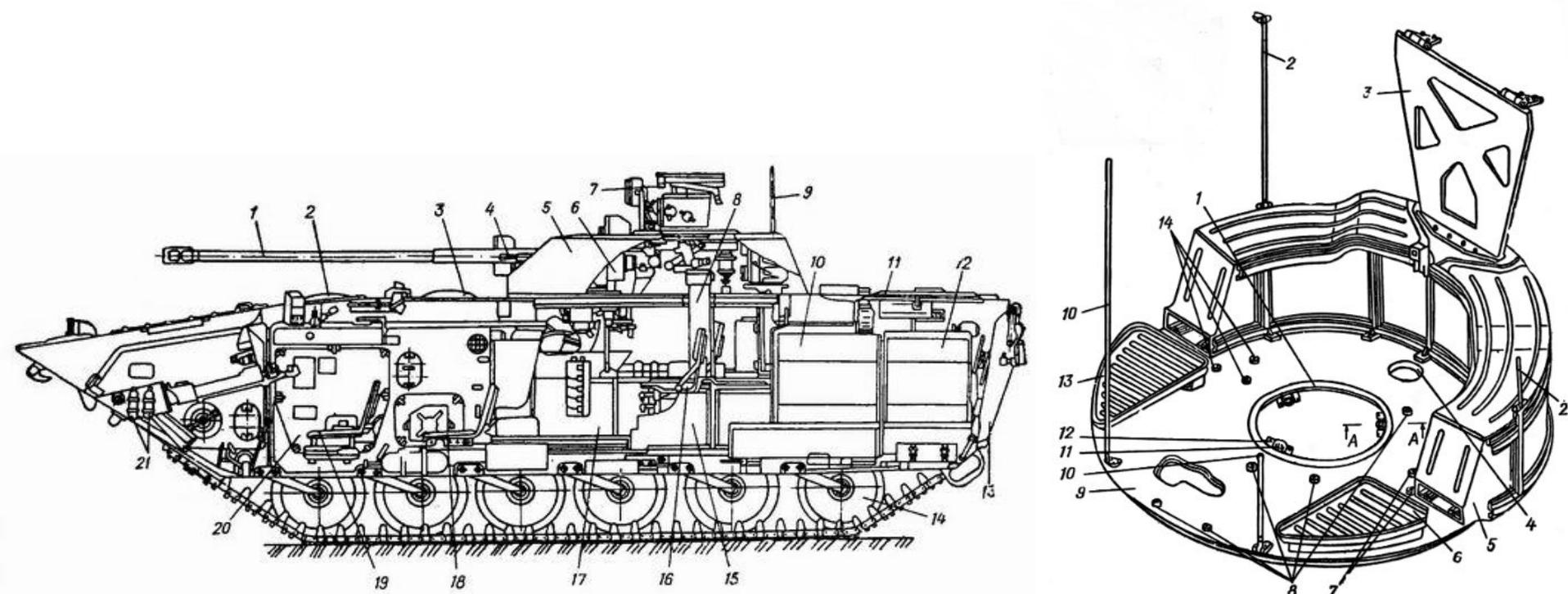
В корпусе боевого отделения на правом борту установлены крепления для укладки трех ПТУР, в нише правого борта укладывается вьючное устройство пусковой установки 9П135М.
