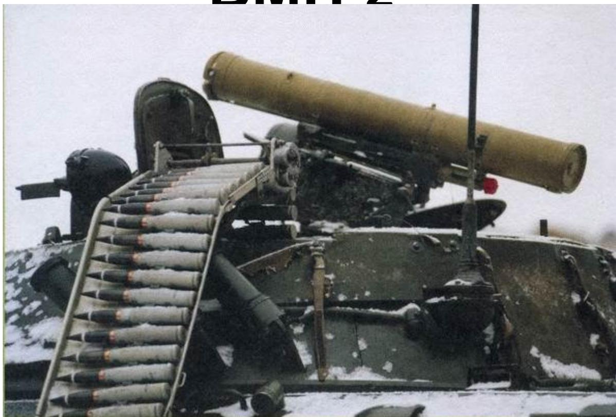
В состав противотанкового комплекса БМП-2 входят пусковая установка машины, ПТУР 9М111 «Фагот» или 9М113 «Конкурс» и пусковая установка 9П135М с наземной аппаратурой управления 9С474 и прибором 9Ш119М1. Запуск ПТУР может производиться как из машины с пусковой установки БМП-2, так и с выносной пусковой установки 9П135М.
