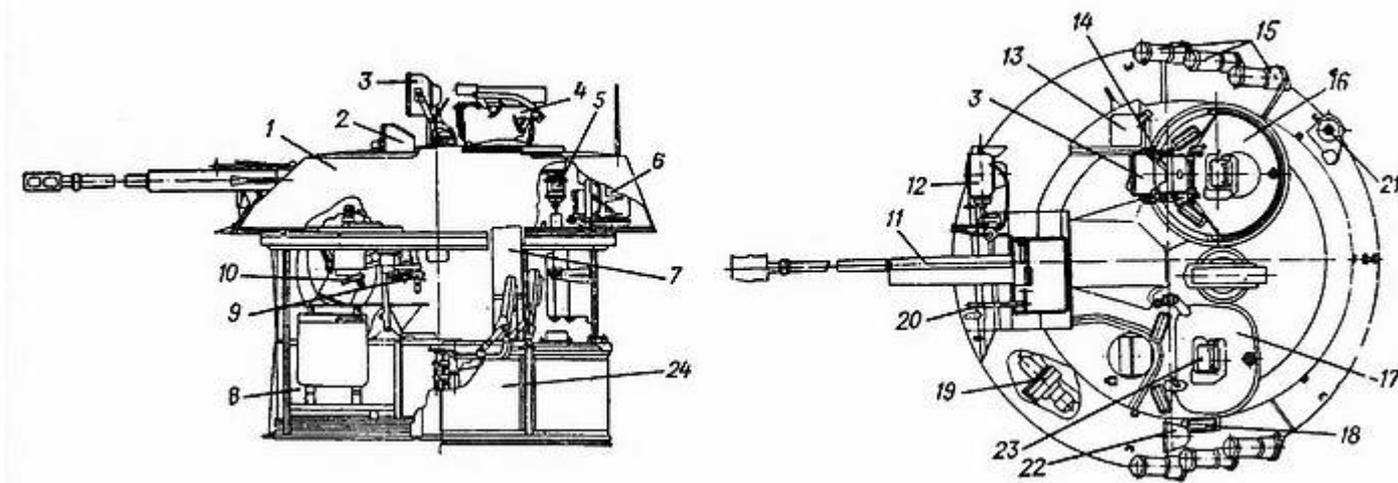
В боекомплекте БМП-2 имеется четыре укладки ПТУР 9М111 (9М111М) или 9М113 (9М113М). Одна расположена по центру и стоит вертикально. Наземная аппаратура управления расположена на водиле башни за спиной оператора.
