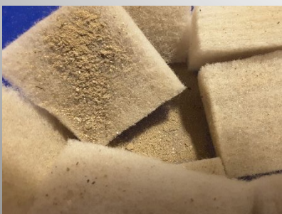
Filterelemente vor der Reinigung
