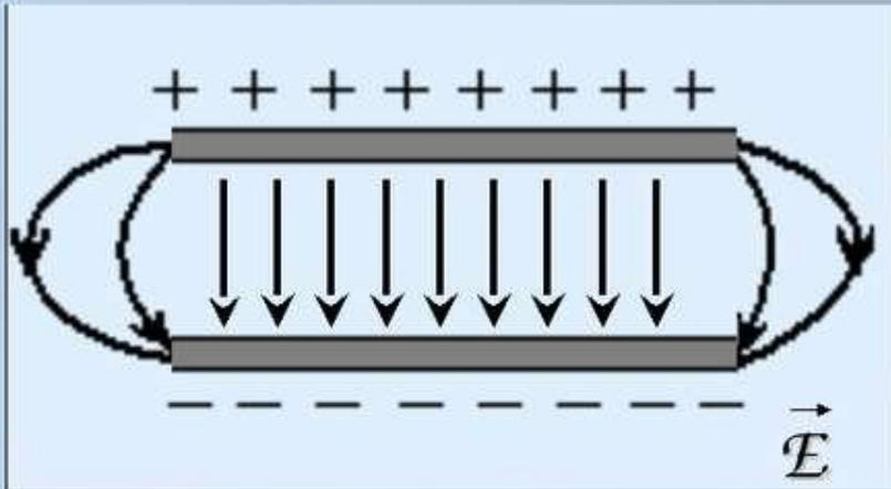
Конденсатор электрический – система из двух или более электродов (обкладок), разделённых диэлектриком, толщина которого мала по сравнению с размерами обкладок.
