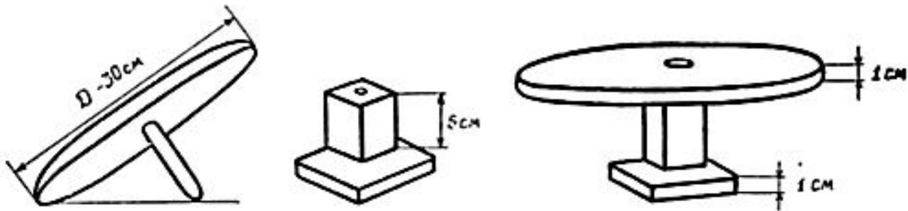
*Рис. Поворотный станок для лепки*
