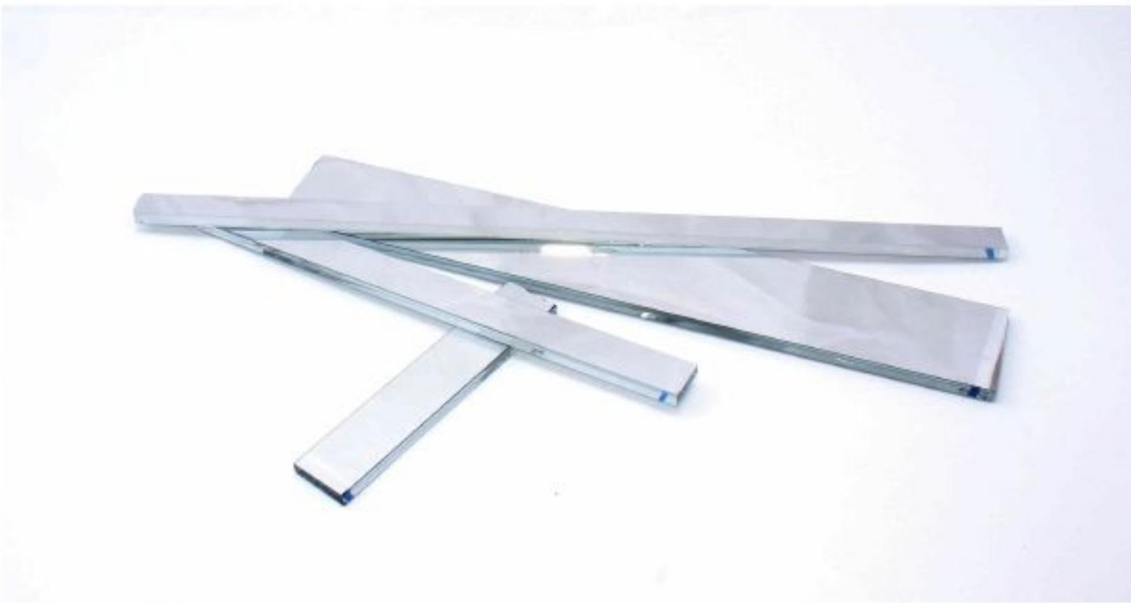
**Рисунок 2.9** Зеркала от оптической системы планшетного сканера. Обратите внимание, оптические зеркала имеют металлизацию стекла снаружи, в отличии от привычных бытовых зеркал, где отражающее покрытие для защиты за стеклом. Бытовые зеркала дают двойное отражение — от поверхности стекла и от отражающего покрытия, что не так критично в быту, как защищенность отражающего покрытия.
