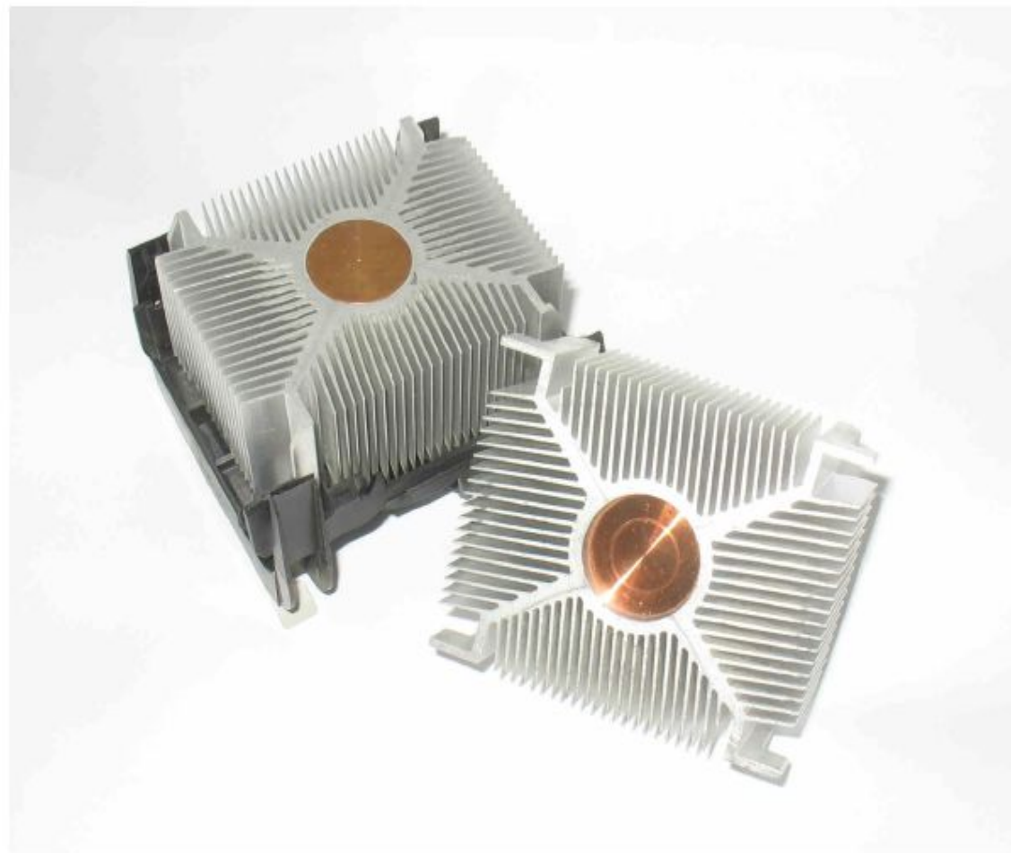
Рисунок 2.5 Радиаторы охлаждения процессора. Центральный стержень изготовлен из меди, он хорошо отводит тепло от кристалла процессора, а алюминиевый радиатор с развитым оребрением уже охлаждает сам стержень.
