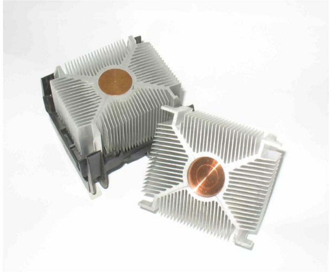
Рисунок 2.5 Радиаторы охлаждения процессора. Центральный стержень изготовлен из меди, он хорошо отводит тепло от кристалла процессора, а алюминиевый радиатор с развитым оребрением уже охлаждает сам стержень.
