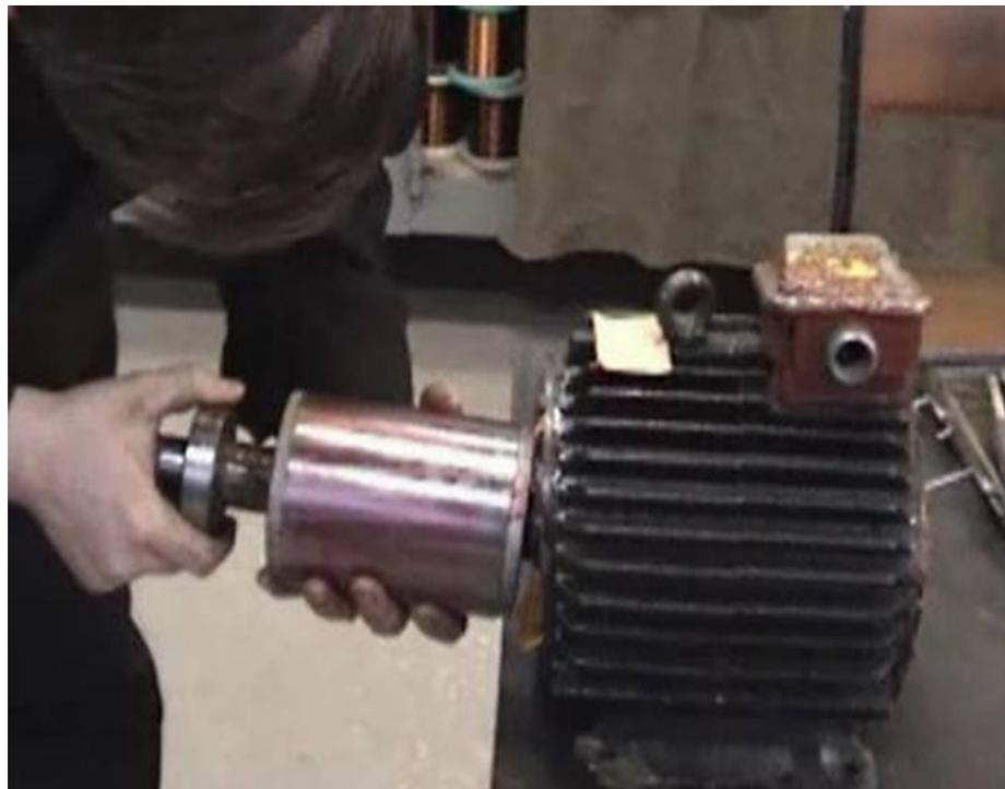
**9. В ходе очистки деталей электрической машины их нужно тщательно отчистить от пыли, грязи и смазочного масла. При необходимости промывки обмоток, нужно обдуть их сжатым воздухом, а затем промыть синтетическими моющими жидкостями нанесенными с помощью пульверизатора. Все очищенные и пригодные для повторного использования детали маркируют и сохраняют, а неисправные отправляют на ремонт или восстанавливают.**
