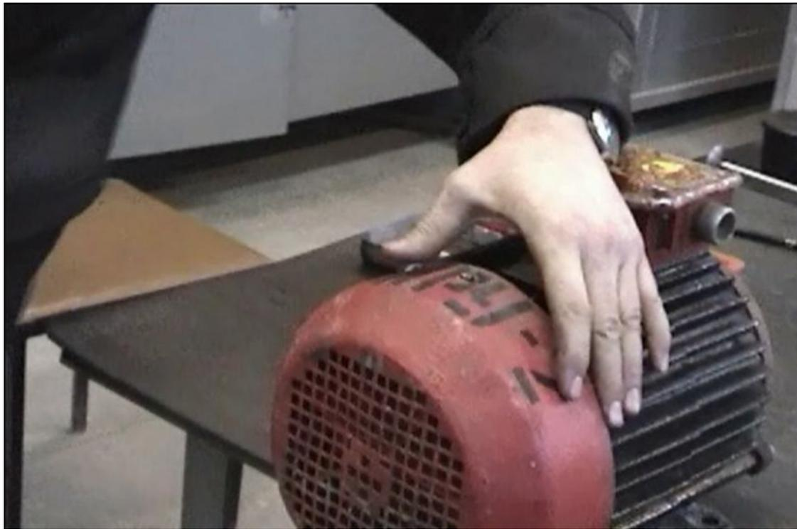
**8. Для выемки ротора из статора нужно подать ротор в сторону переднего щита и вывести из зажима, далее поддерживая ротор следует вывести его из статора.**
