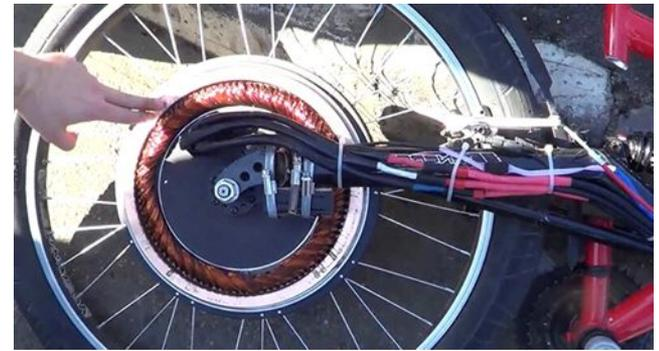
ПРИНЦИПИАЛЬНО новый асинхронный двигатель. Суть технологии — использование дополнительных обмоток статора. Для трёхфазного электродвигателя используются помимо трёх основных обмоток три дополнительных — совмещенных — расположенных определенным геометрическим образом и также специальным образом соединенных между собой.
