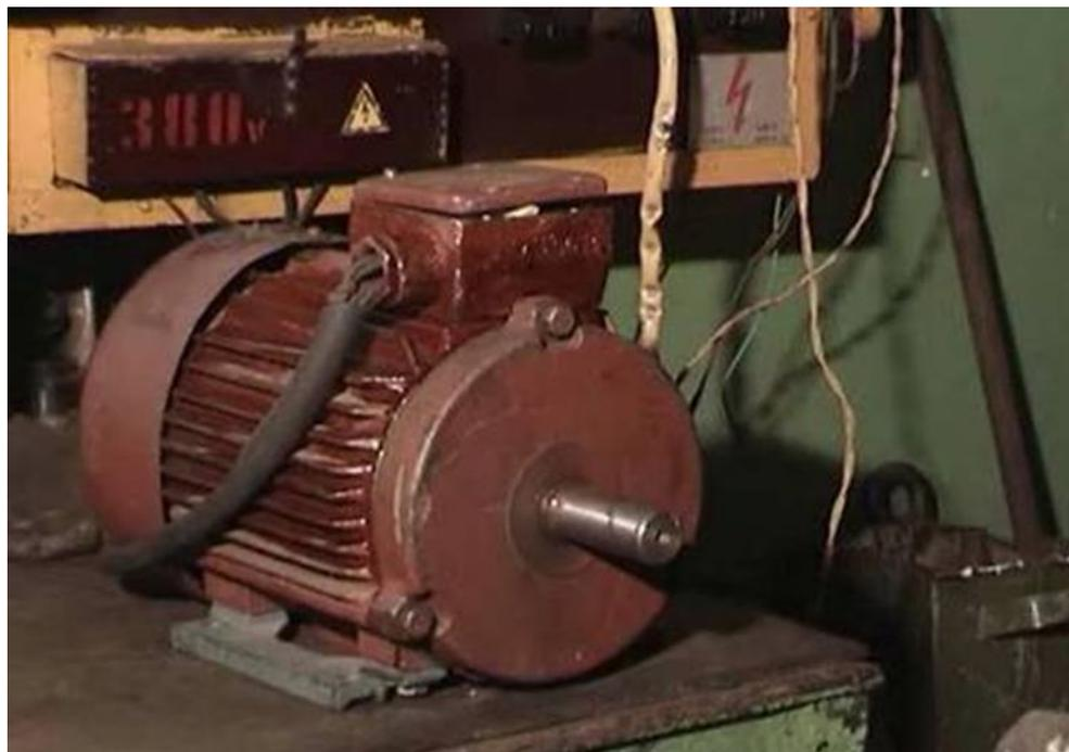
**7. В процессе разборки машины необходимо снять кожух наружного вентилятора, сам вентилятор и отвернуть болты крепящие к станине передние и задние щиты. Подшипниковые щиты снимают при помощи легких ударов молотка.**
