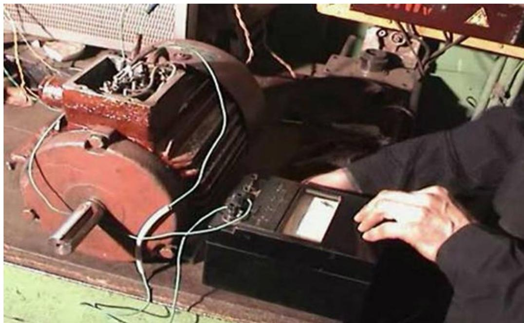
**6. Проверку электрической машины на целостность подшипников, величину осевого разбега ротора проводят на холостом ходу при наличии характерного звука и вибрации вращающихся частей машины.**
