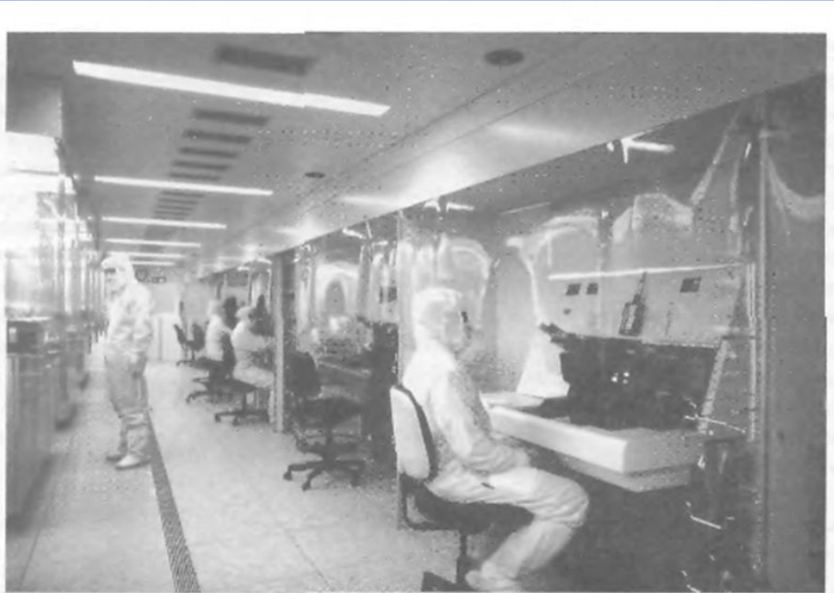
Рис. 7.4. Производственные участки, спроектированные по принципу чистых туннелей
