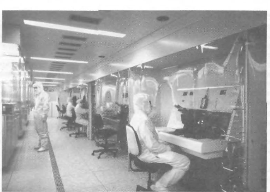
Рис. 7.4. Производственные участки, спроектированные по принципу чистых туннелей
