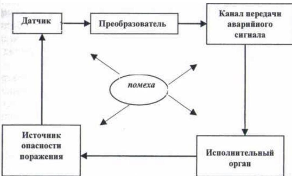
это автоматическое отключение электроустановки при возникновении в ней опасности поражения электрическим током. Структурная схема УЗО
